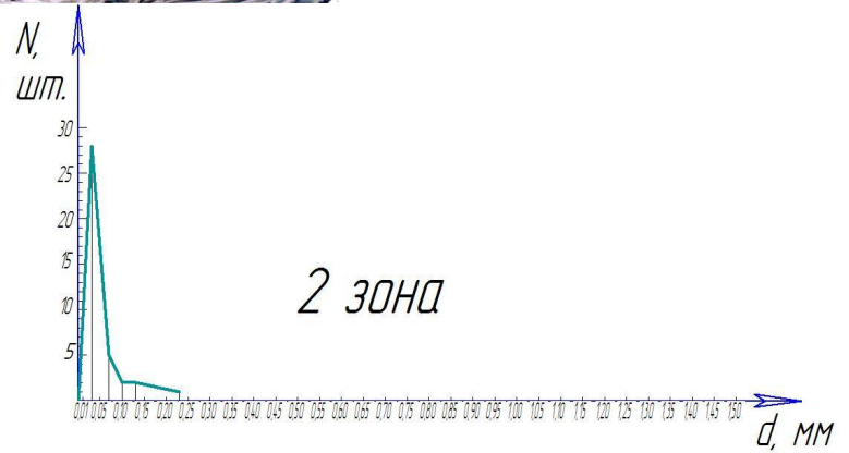
Рис. 3. Дослідження у II зоні від поверхні виливка: а) структура; б) залежність кількості дефектів N від їх розмірів d
