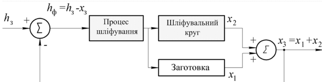
Рис. 3 – Функціональна схема замкнутої динамічної системи переривчастого шліфування
