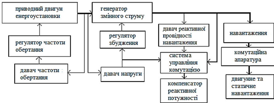
Рис. 4 - Структура математичної моделі автономної електроенергетичної системи з компенсацією реактивної потужності
