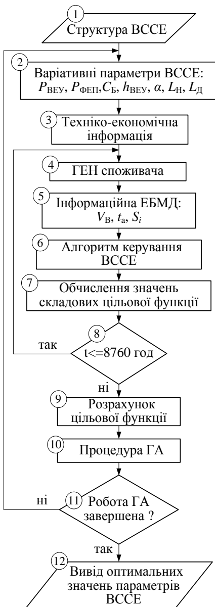
Рис. 7. Блок-схема методики техніко-економічної оптимізації параметрів складових елементів ВССЕ
