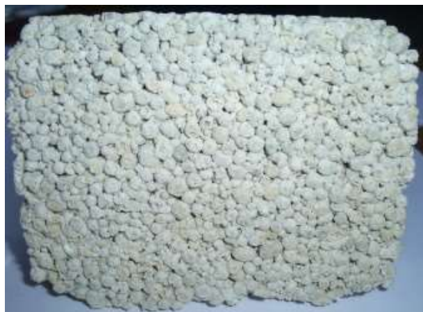
Рисунок 6.7 – Фотографія фрагменту теплоізоляції з запропонованого керамзиту, що використовувався на підприємстві
