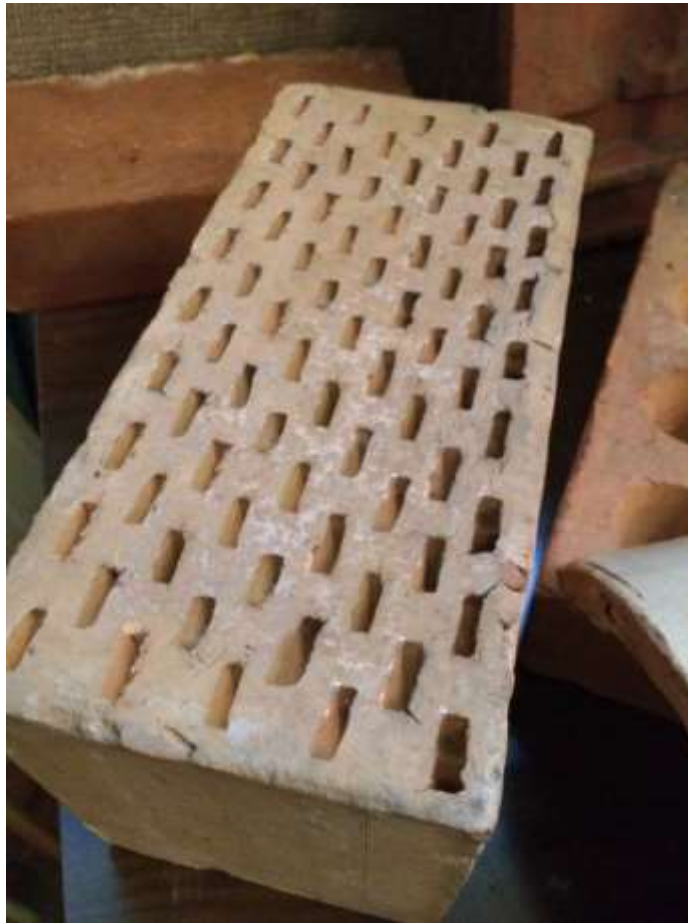
Рисунок 6.9 – Фотографія цегли, отриманої шлікерним литтям
