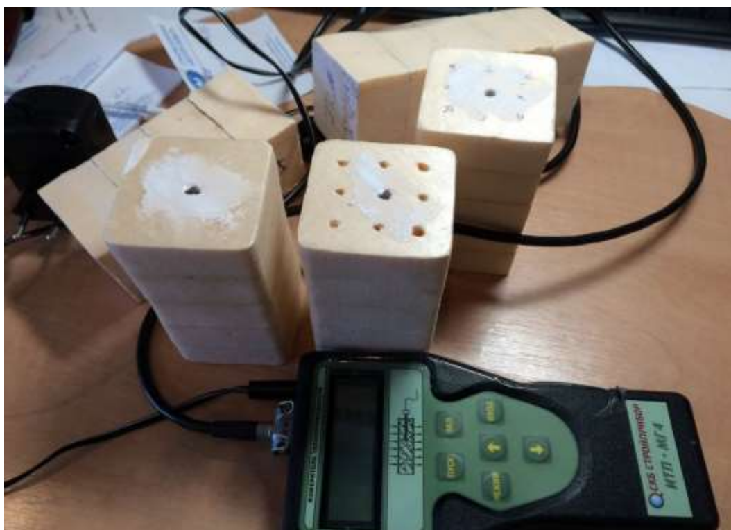
Рисунок 5.32 – Фото дослідницьких зразків теплоізоляційного матеріалу з порами
