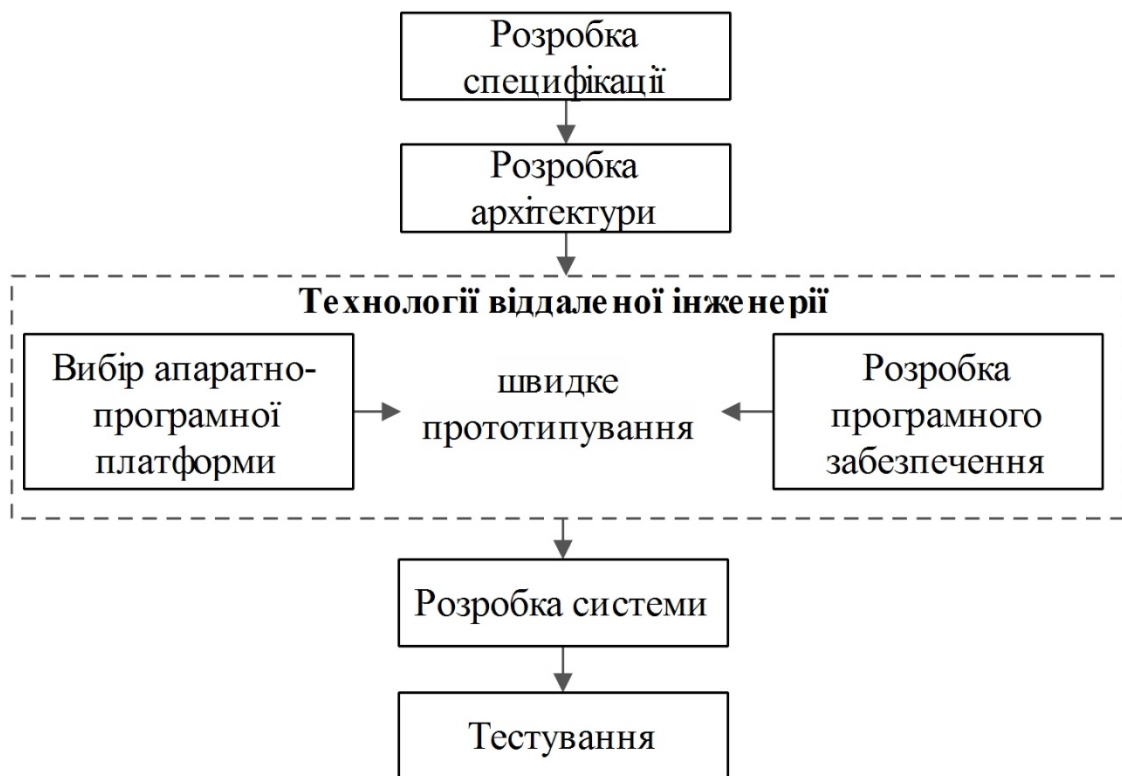
Рис. 2.4. Удосконалена схема методу паралельного проектування ВС
