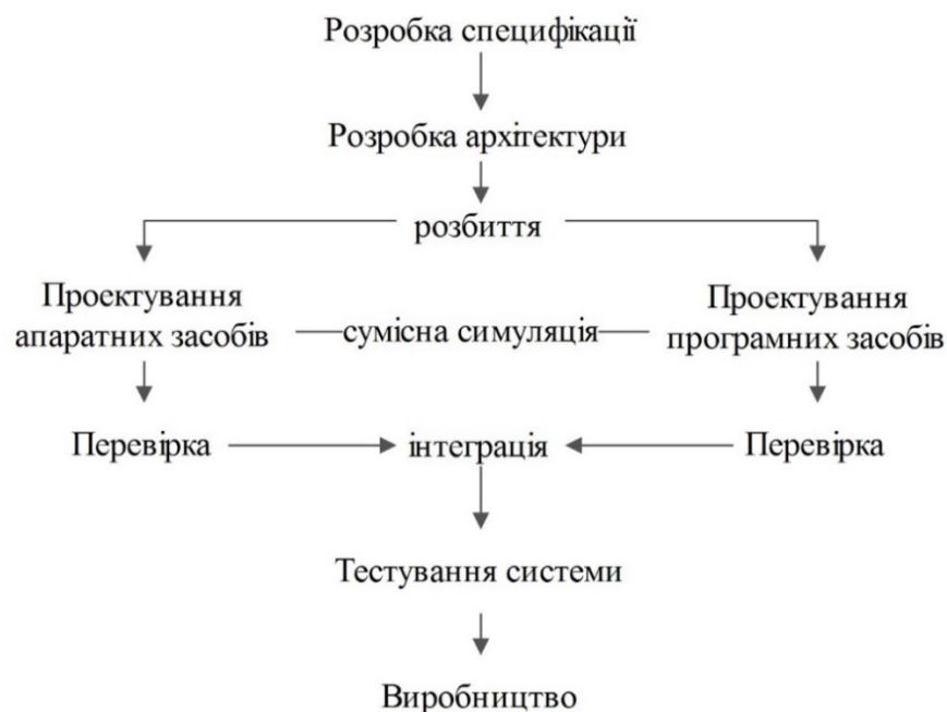
Рис. 1.5. Узагальнена схема методу паралельного проектування ВС
