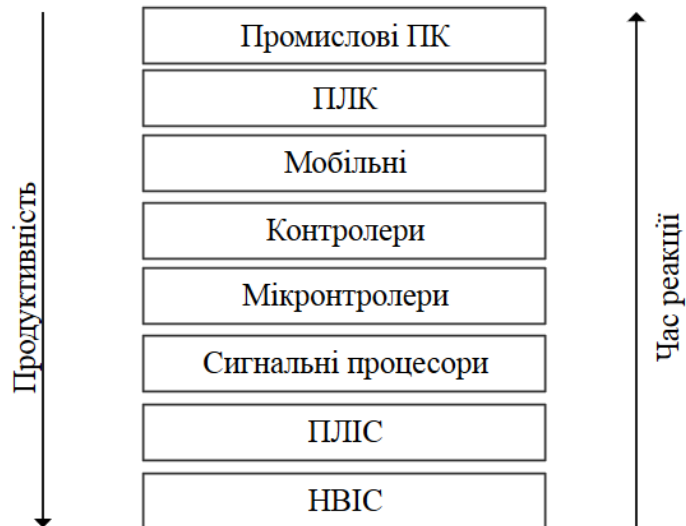
Рис. 1.4. Технології реалізації вбудованих систем
