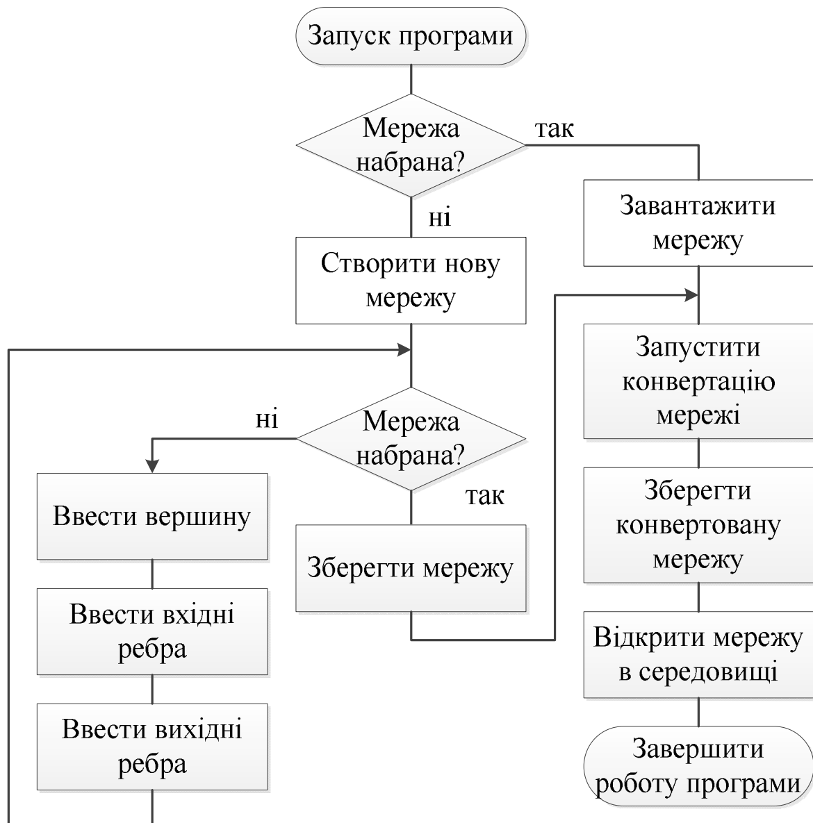
Рис.4.2. Блок-схема алгоритму роботи системи
