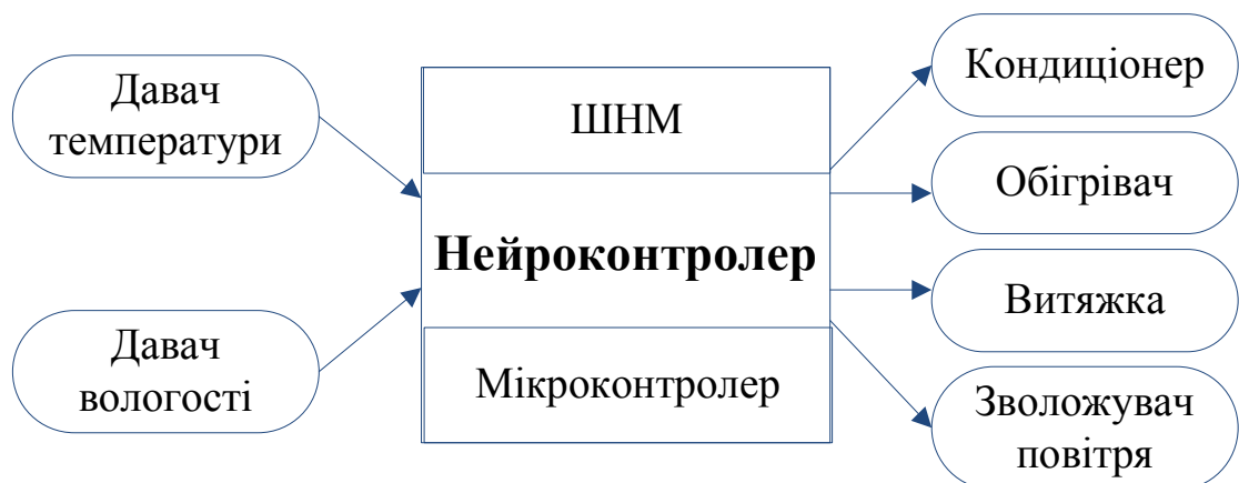
Рис. 2.4. Структура підсистеми клімат-контролю однієї з кімнат
