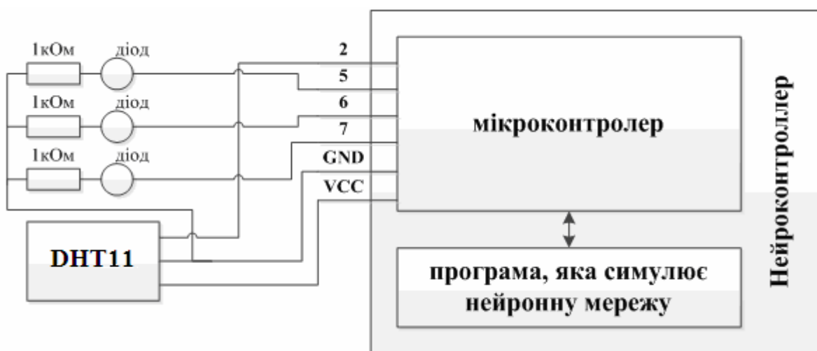
Рис. 4.16. Схема підключення підсистеми клімат-контролю
