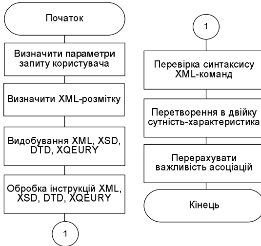
Рис. 3. Схема конвертації реляційних таблиць у XML-БД з врахуванням моделі «сутність-характеристика»
