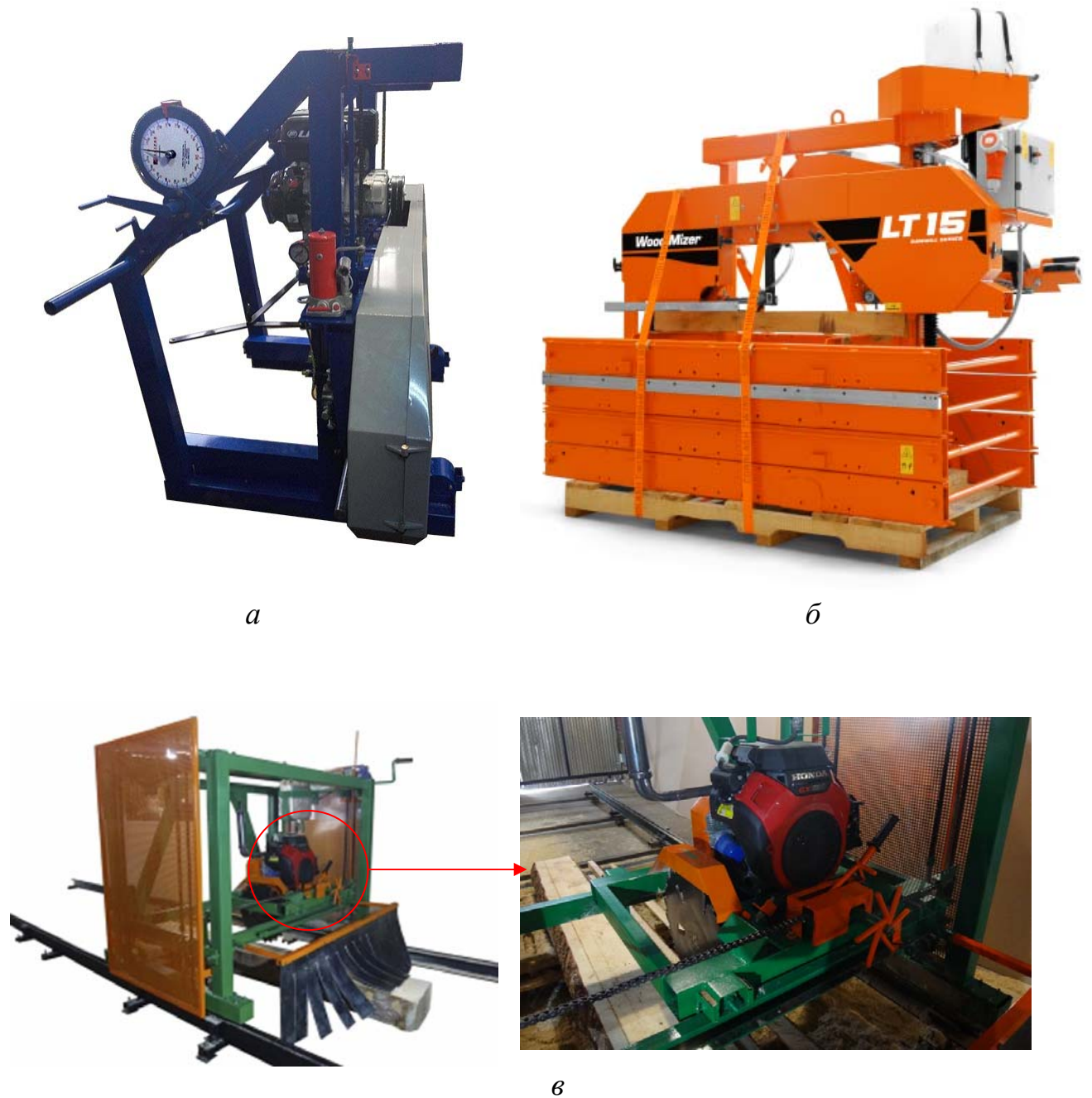
Рисунок 1.11 — Пилорами: а — стрічкова для поздовжнього і горизонтального розпилювання колод і брусів різних довжини і товщини, як обрізної, так і не обрізної деревини хвойних і листяних порід (потужність двигуна приводу — 13 к.с., а двигуна підйому — 0,37 кВт); б — такого самого призначення стрічкова пилорама для приводу якої передбачена можливість використання бензинового двигуна потужністю 14 чи 18 к.с. або дизельного потужністю 10 к.с.); в — дискова пилорама з бензиновим двигуном Honda потужністю 20 л.с. (14,91 кВт), що призначена для розпилювання круглого лісу на всі види пиломатеріалів
