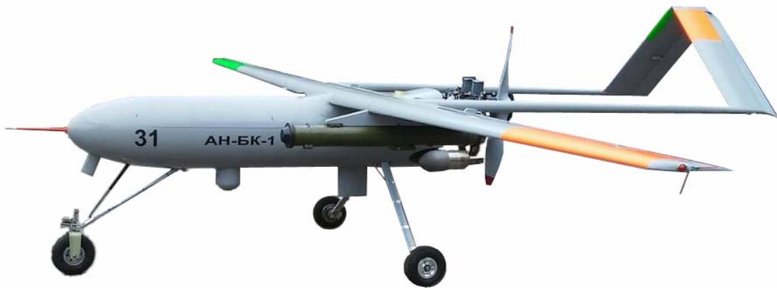
Рисунок 1.14 — Літальний апарат багатофункційного безпілотного авіаційного комплексу АН-БК-1 «Горлиця» з двигуном внутрішнього згоряння
