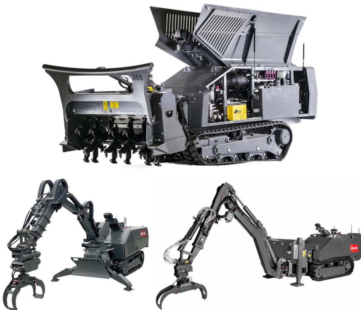
Рисунок 1.12 — Платформа на гумових гусеницях з різними навісними пристроями чи маніпуляторами (габарити без навісного обладнання, мм: довжина — 2700, ширина — 1000, висота — 1400; маса без навісного обладнання — 1770 кг, з обладнанням — 2240 кг; швидкість пересування — до 6 км/год, а розмінування — 0,3...1,0 км/год)
