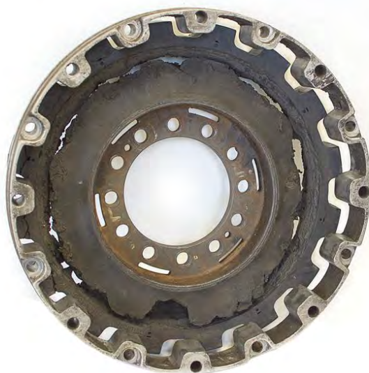
Рисунок А.27 – Пружні елементи муфти VULKAN Vulastik L з розірваною мембраною
