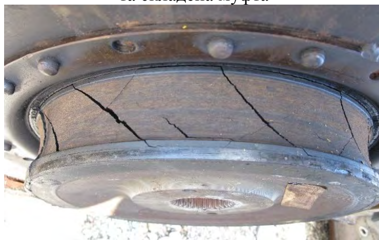
Рисунок А.29 – Пружний елемент елементи муфти VULKAN Vulkardan E з тріщинами
