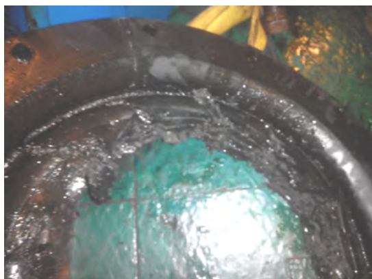
Рисунок Б.3 – Зруйнований пружний елемент муфти VULKAN EZR 1422
