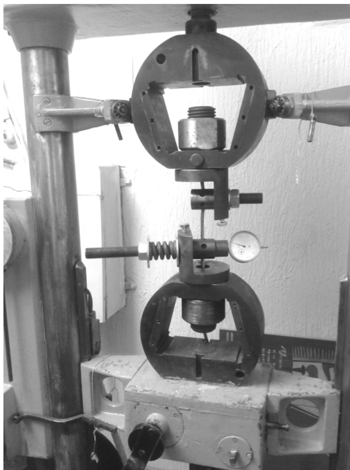
Рисунок 6.4 - Вимірювання зусилля опору екстракції каната на розривній машині УММ-5
