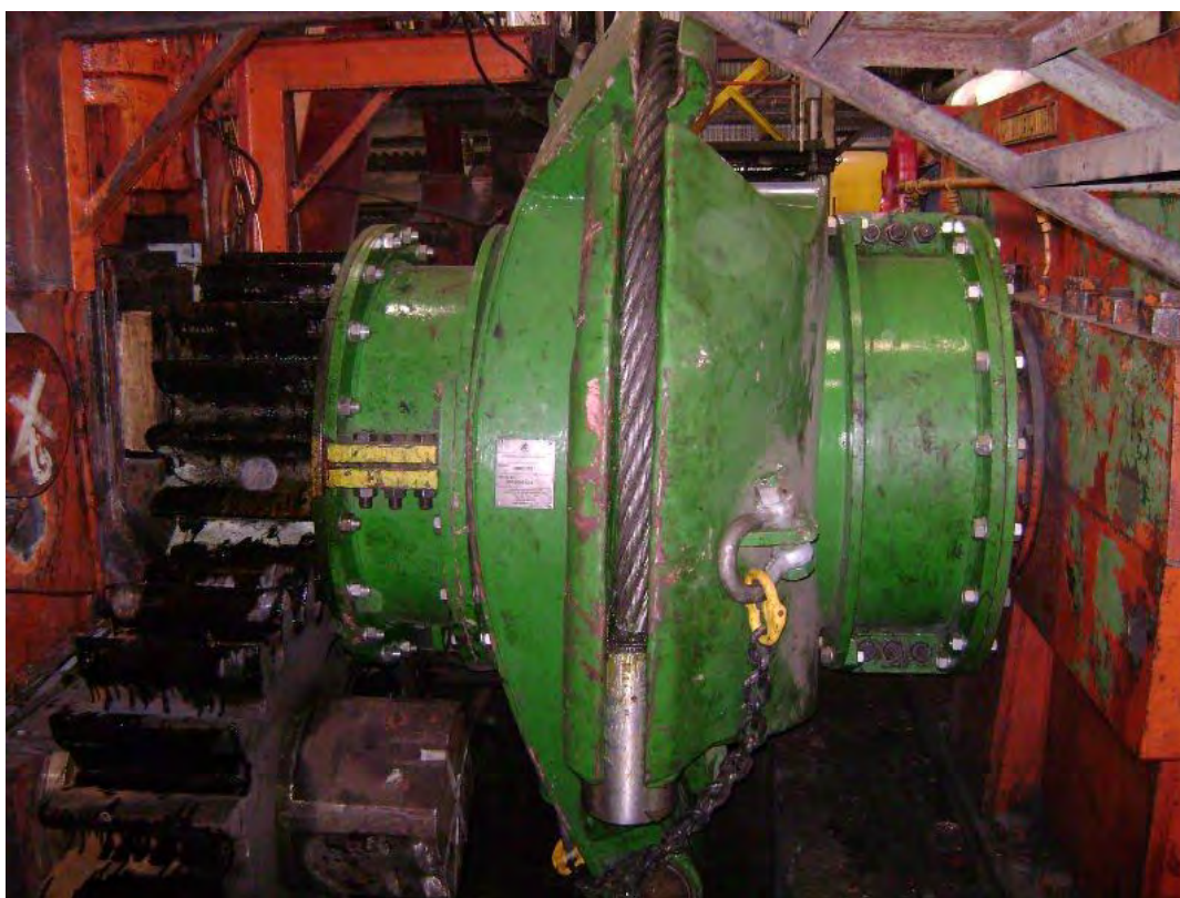
Рисунок 7.14 – Муфта з канатними ланками в приводі цукрового млина фірми Stemex™
