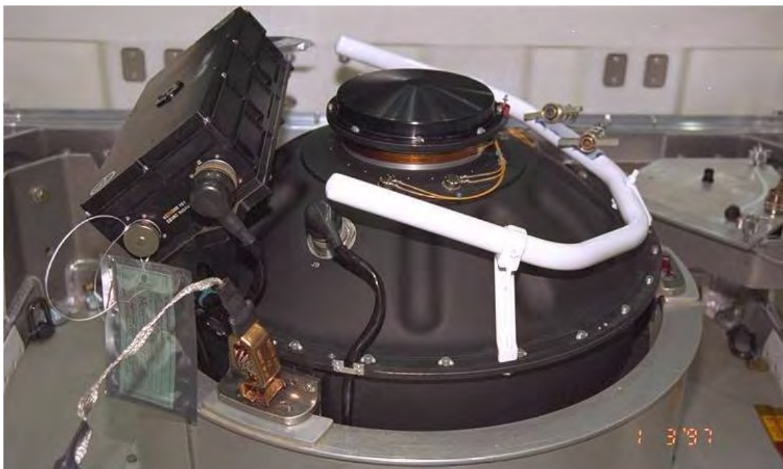
Рисунок Г.3 – Один із маховиків телескопа «Хаббл», встановлений на канатних віброізолюючих опорах
