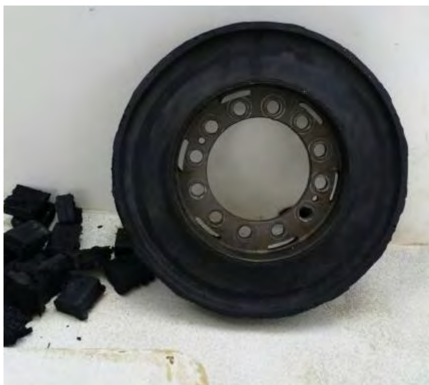
Рисунок А.26 – Пружний елемент муфти VULKAN Vulastik L зі зрізаними виступами
