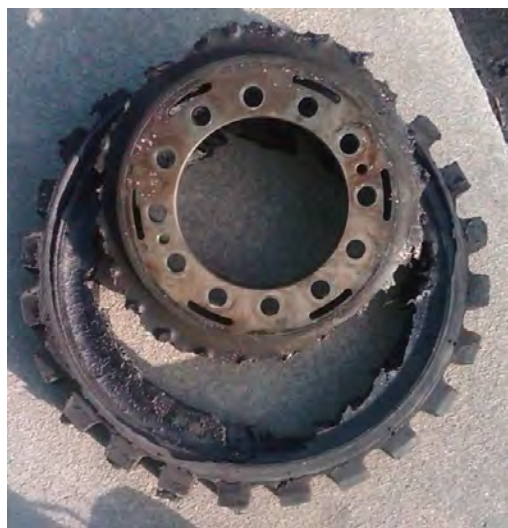
Рисунок А.27 – Пружні елементи муфти VULKAN Vulastik L з розірваною мембраною
