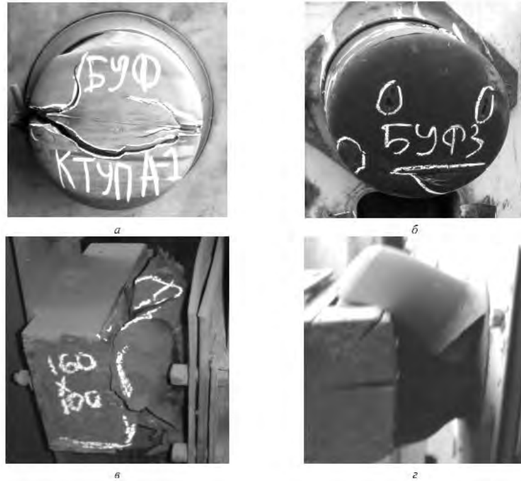
Рисунок В.1 – Пошкоджені (а, б) та зруйновані (б, в) гумові буфери мостових кранів
