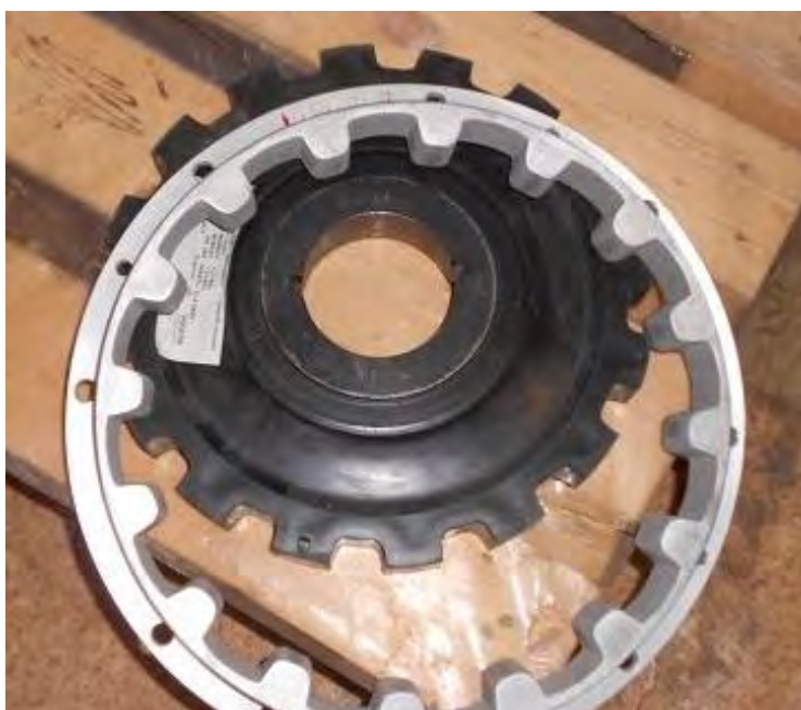
Рисунок А.25 – Муфта VULKAN Vulastik L, її пружний елемент та зовнішня обойма
