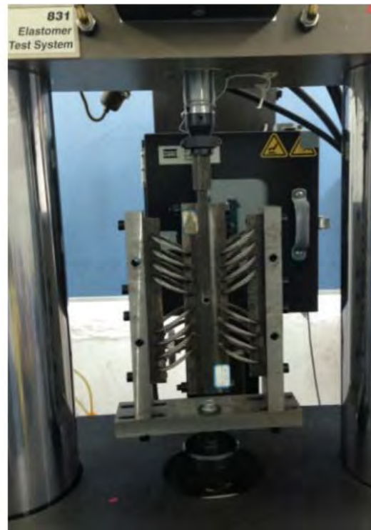
Рисунок Г.9 – Досліджувані віброізолятори «Helical» на стенді при випробуваннях в умовах «перекочування» та «зсуву» [210]
