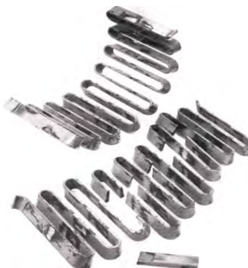
Рисунок А.6 – Зруйнована змієподібна пружина пружної муфти
