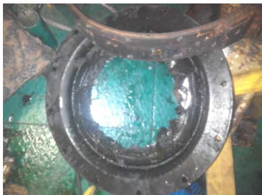
Рисунок Б.3 – Зруйнований пружний елемент муфти VULKAN EZR 1422
