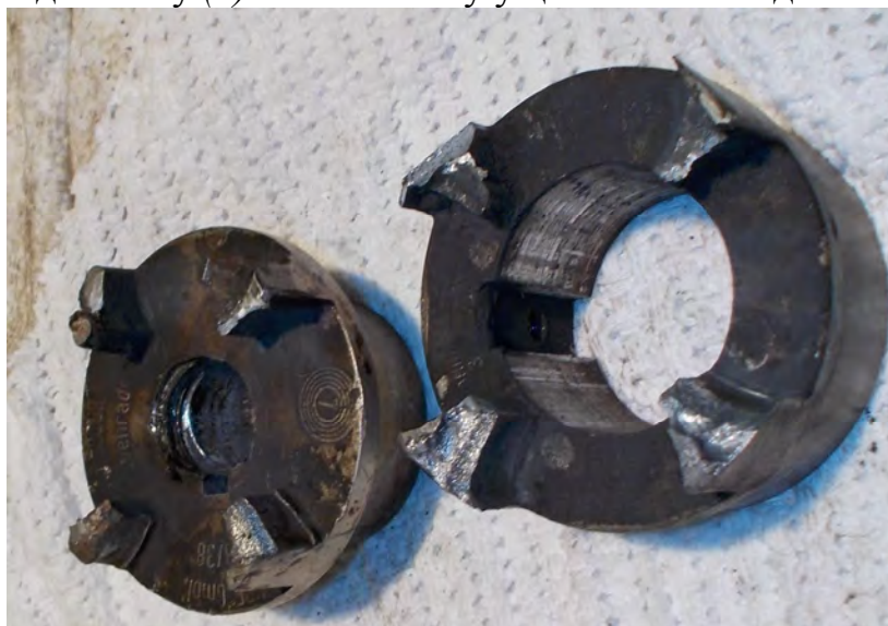
Рисунок А.17 – Загальний вид демонтованих ведучої та веденої напівмуфт зі зруйнованими виступами через їх безпосередній контакт після руйнування пружної зірочки
