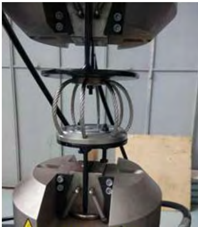
Рисунок Г.10 – Досліджувані віброізолятори «Polysal» на стенді при випробуваннях в умовах розтягу [213]
