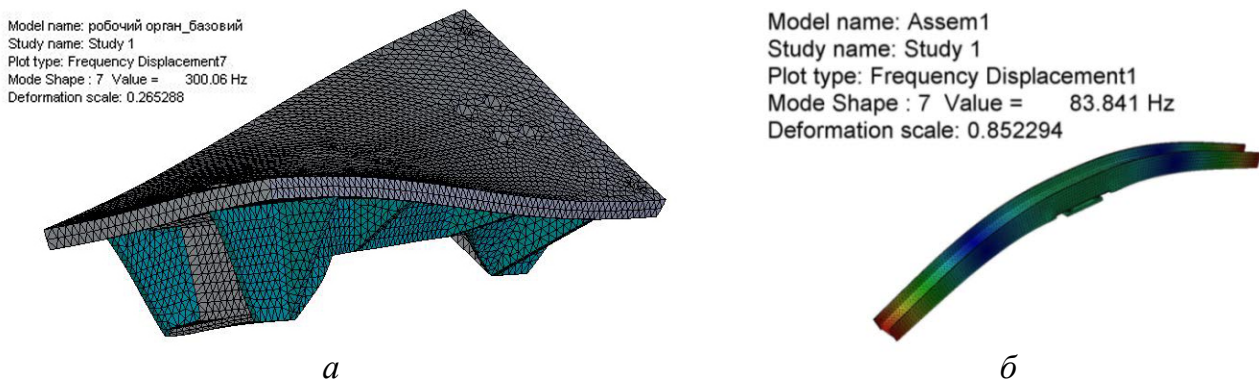
Рисунок 12 – Значення власних частот крутильних (а) і згинальних (б) коливань оптимізованих конструкцій робочих органів
