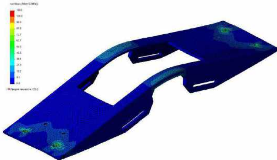
Рисунок 5.10 – Напружено-деформований стан верхньої траверси
