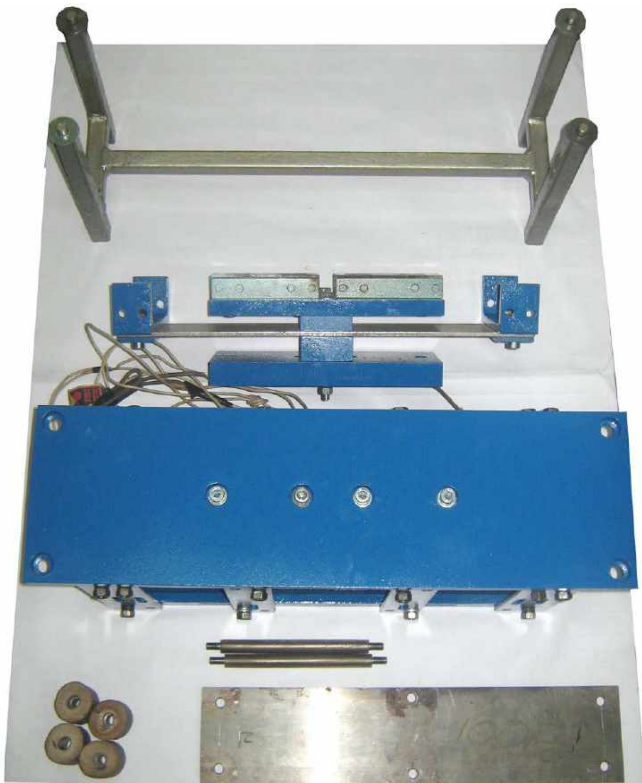
Рисунок 5.12 – Основні вузли та деталі експериментального взірця віброударного модуля (зверху вниз): рама, реактивний модуль, робоча маса, циліндричні опори, гумові віброізолятори, плоска пружина
