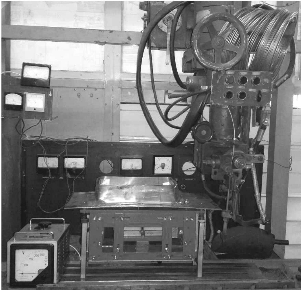
Рисунок 5.22 – Вигляд обладнання для наплавлення зносостійких шарів під шаром флюсу з використанням розробленого віброударного модуля
