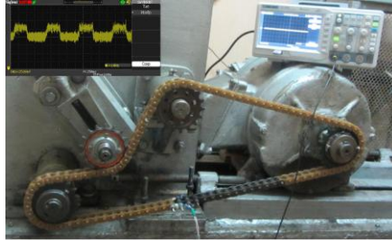
Рисунок 18 – Експериментальний стенд дослідження динаміки багатомасового ланцюгового привода, оснащеного металевими (ліворуч), металополімерними (в центрі) та полімерними (праворуч) деталями ланцюгової передачі
