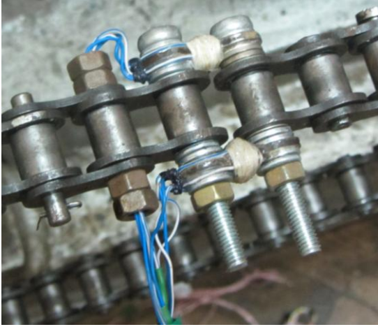
Рисунок 17 – Вимірювальна ланка, встановлена в металевому (ліворуч) та полімерному (праворуч) ланцюгових контурах передачі
