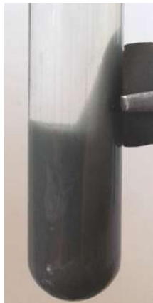
Рис. 5.19. Прояв магнітних властивостей порошками відновленого нікелю
