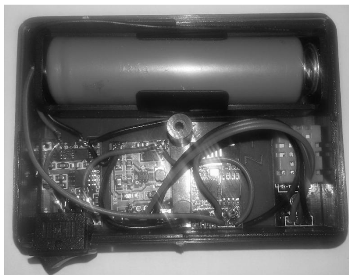
Рис. 5.10. Конструкція сенсорного вузла прототипу СВВП
