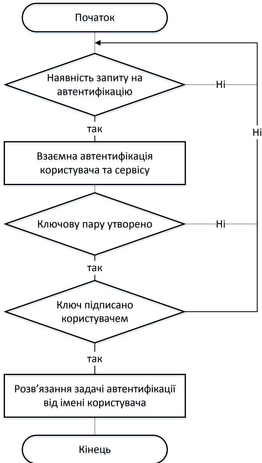
Рис.2.2 Узагальнена схема алгоритму автентифікації із застосуванням біометричної інформації з маскуючими елементами.
