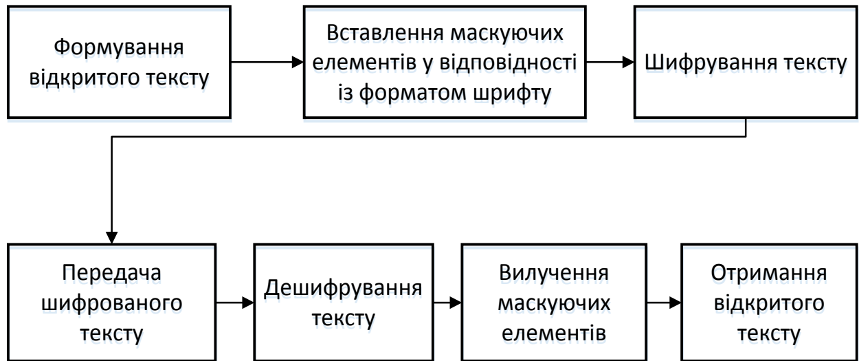
Рис. 3.2. Структурна схема шифрування даних із використанням маскуючих елементів
