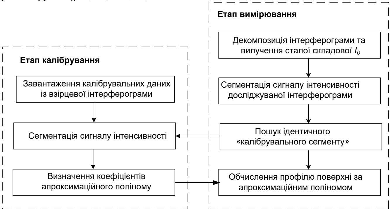
Рисунок 3. Послідовність обчислень для реконструкції профілю поверхні за методом посегментної апроксимації
