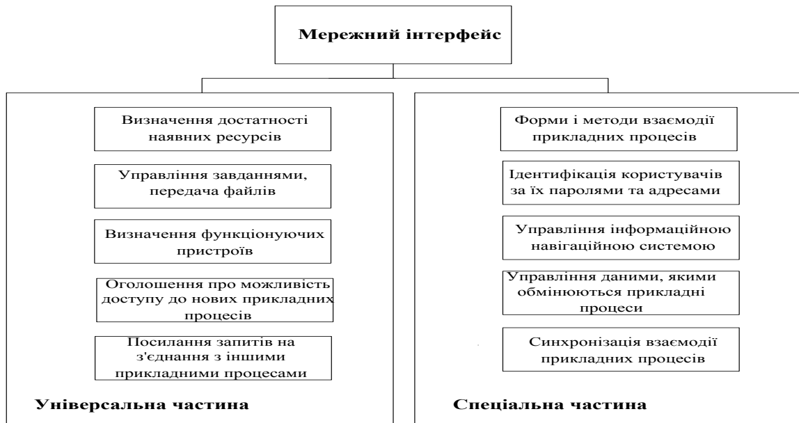
Рис. 1. Схема модульного мережного інтерфейсу НС кіберфізичних систем
