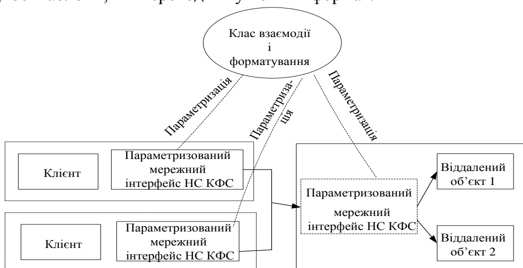
Рис. 3. Модель параметризованого мережного інтерфейсу НС кіберфізичних систем
