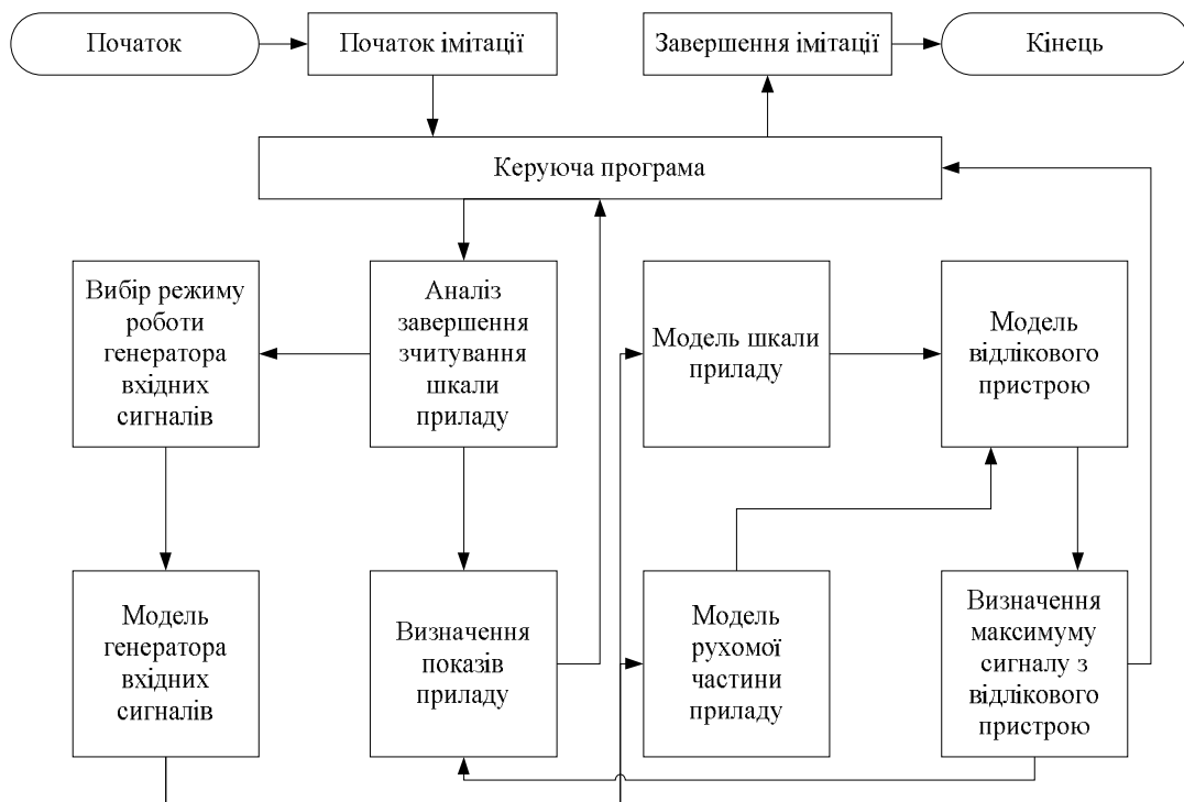
Рисунок 1.9 – Схема функціональної взаємодії алгоритмічних компонентів системи автоматичної повірки
