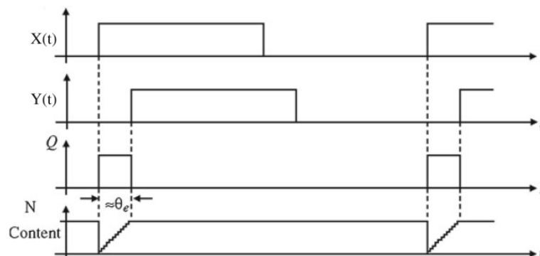
Рисунок 1.3 – Принцип роботи ФД на базі JK- (RS-) – тригера, [36]
