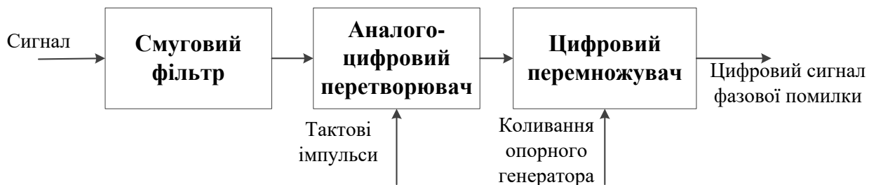
Рисунок 1.7 – Фазовий детектор цифрового пристрою ФАПЧ з рівномірною дискретизацією (Nyquist-Rate DPLL), [36]
