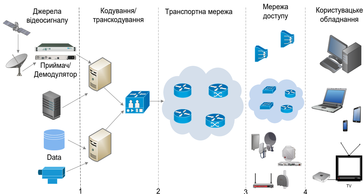
Рис. 1.10. Спрощена схема проходження відеотрафіку в мережі Інтернет.
