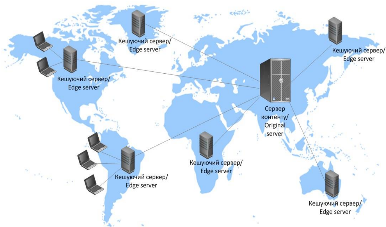
Рис. 4.2. Узагальнена схема географічно рознесеної мережі CDN.
