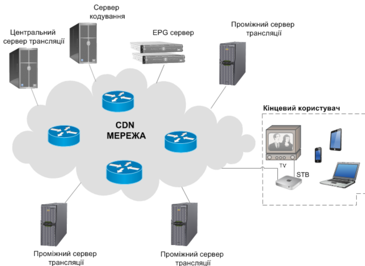
Рис. 4.6. Типова архітектура мережі CDN.
