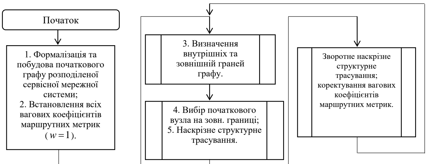
Рис. 10. Алгоритм коректування вагових коефіцієнтів маршрутних метрик для балансування сервісного навантаження за допомогою наскрізного структурного трасування в хмарній мережній платформі [5]
