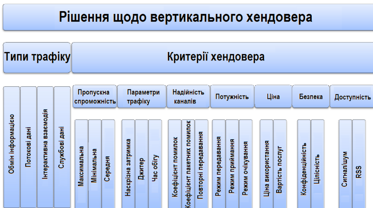
Рис. 5.5. Типи трафіку та критерії прийняття рішень щодо хендовера.
