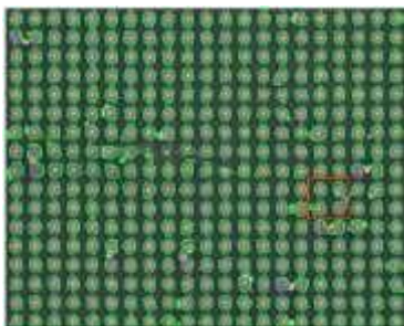
Рис. 3.9. РЕМ (JCM-5000) - зображення тест-об'єкта M=8000^x після морфологічної фільтрації з нанесеними контурами вузлів, побудованими колами, центроїдами та центрами кругів
