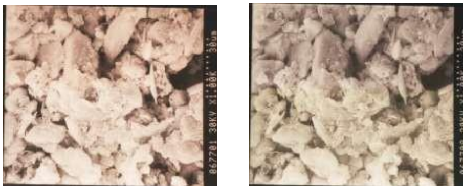
Рис. 4.1. Стереопара мікроповерхні лесового ґрунту, отримана на РЕМ «Hitachi» S-800 при M = 1000^x і кутах нахилу гоніометричного столика \alpha_l = 0^\circ , \alpha_n = +8^\circ
