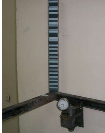
Рис. 3.8 Скан кодової рейки закріпленої на куті рами
