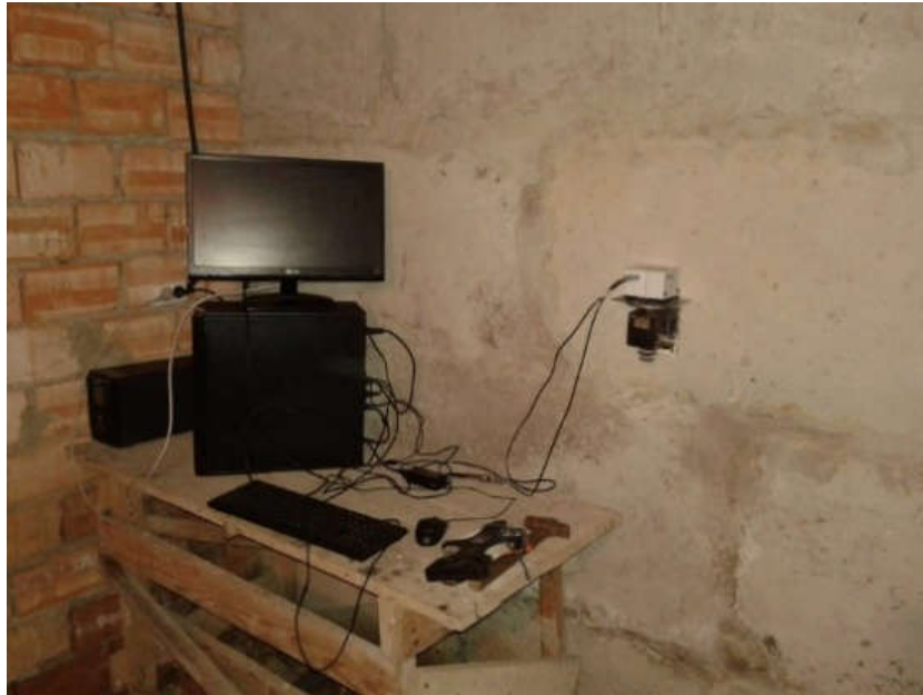
Рис. 4.7 Нахиломірна станція Nivel 210 встановлена в школі с. Модричі
