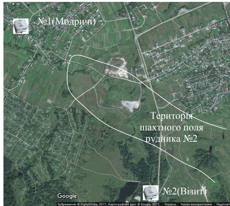
Рис. 4.6 Місця встановлення інклінометрів
