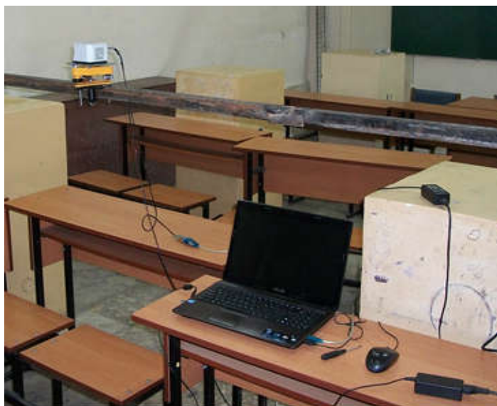
Рис. 3.6 Інклінометр встановлений на рамі та під'єднаний до комп'ютера.
