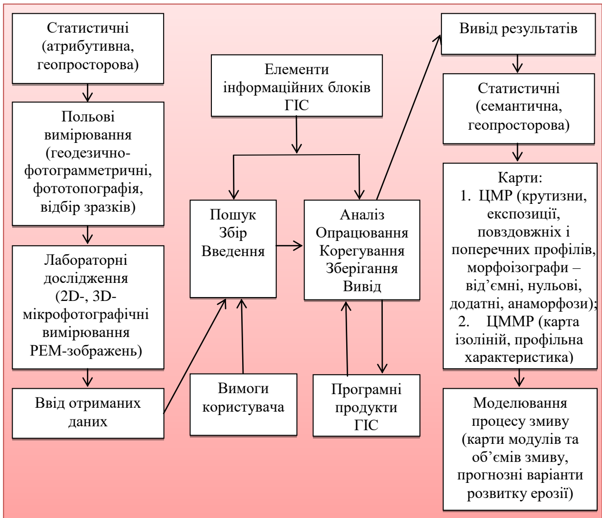
Рис.1.3. Технологічна схема етапів опрацювання інформації ерозійних процесів програмними продуктами ГІС
