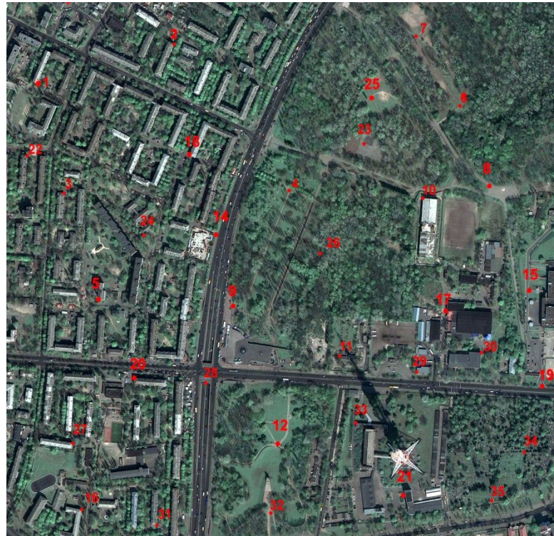
Рис.2.5. Космічний знімок отриманий з супутника Geo Eye – 1 з замаркованими опорними та контрольними точками
