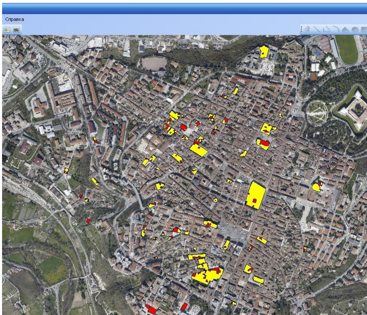
Рис.4.9. Векторизовані шари будинків до та після землетрусу з результатами оверлею
