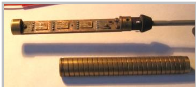
Рис. 1.16. Фото спеціальної вставки з закріпленими на ній зразками НК для проведення вимірювань у гелієвому кріостаті типу ГКОП
