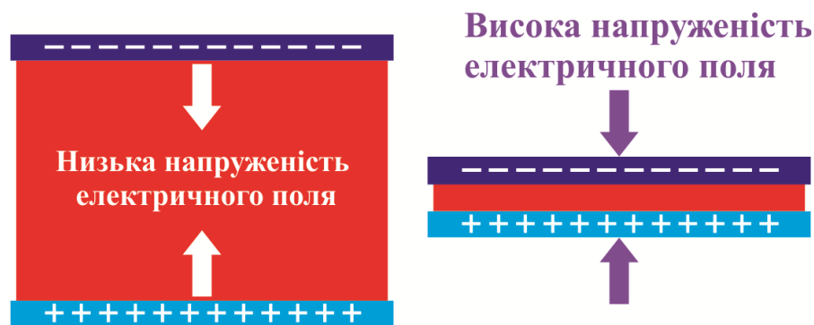
Рис.1.6. Розподіл електричного поля в об'ємі плівки органічного напівпровідника [55].
