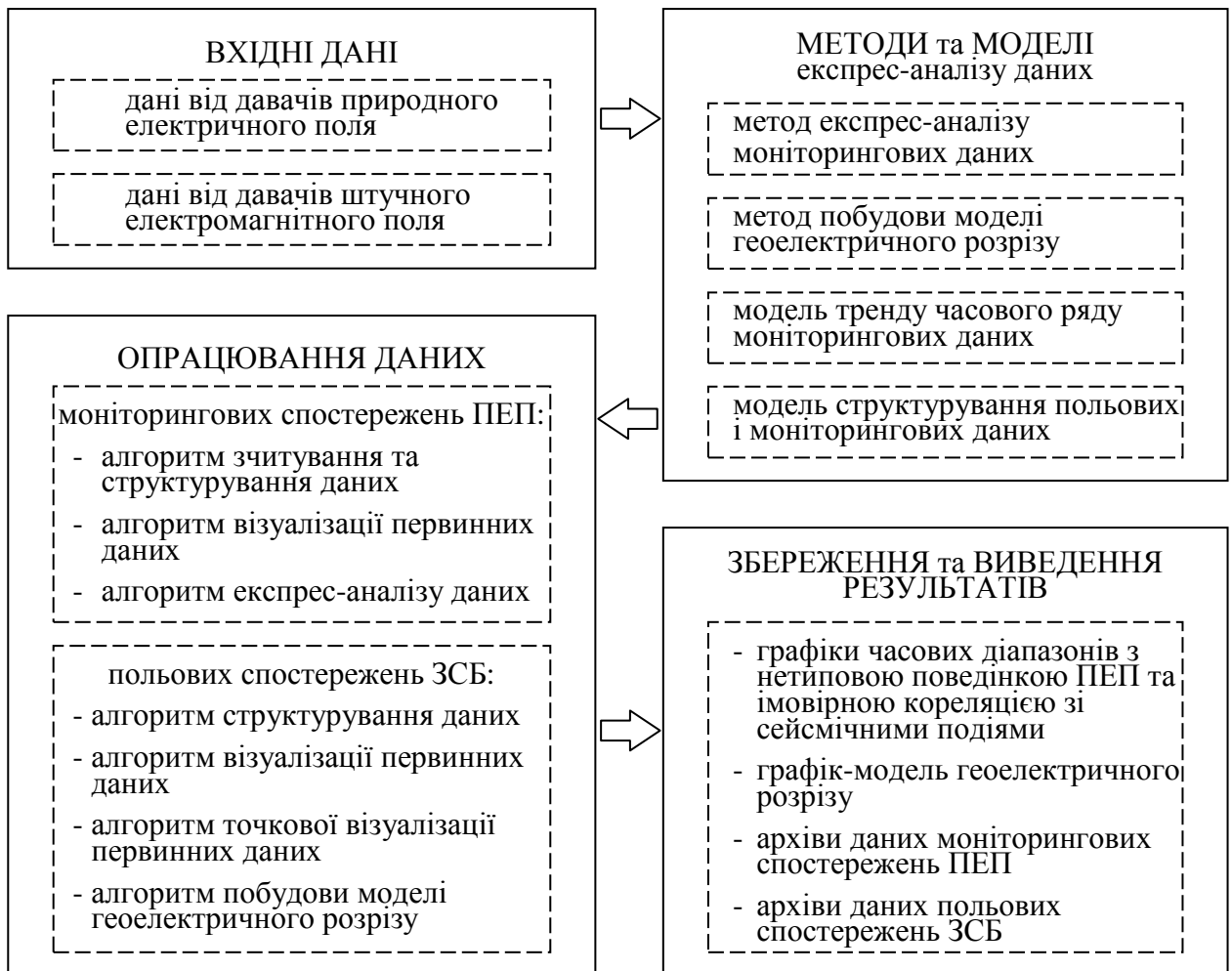
Рисунок 4.1 – Структурно-функціональна модель інформаційної технології експрес-аналізу даних геоелектромагнітних спостережень
