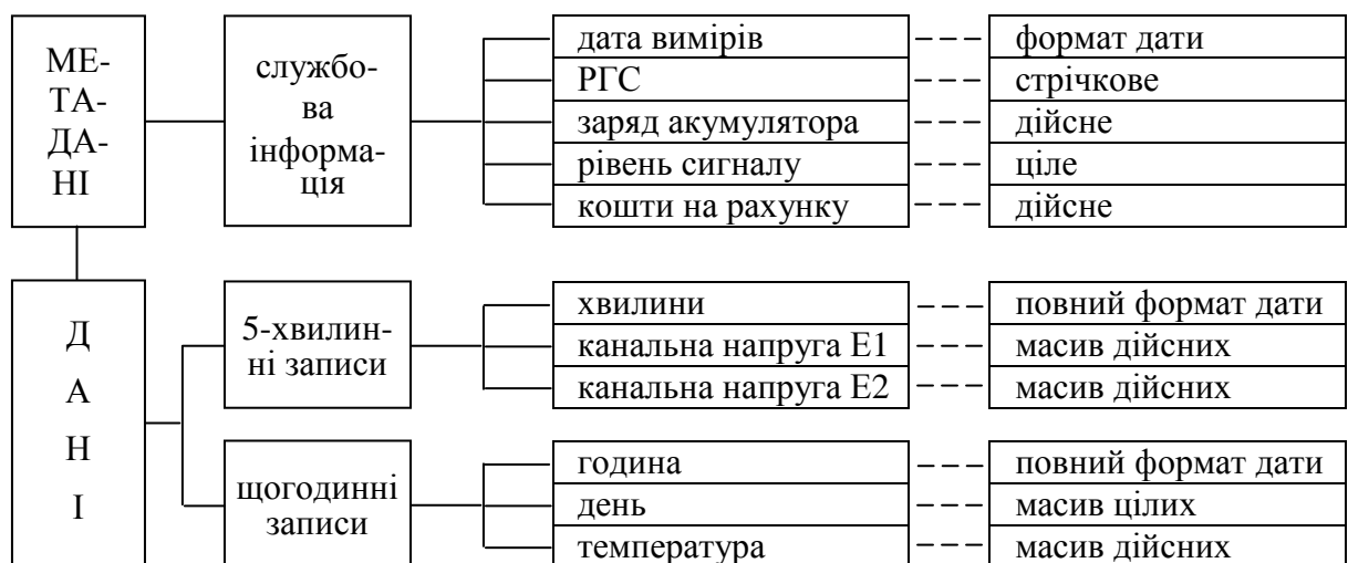
Рисунок 2.6 – Інформаційна модель структурування моніторингових даних
