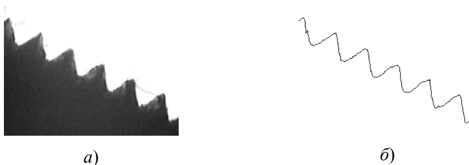
Рис. 1.2. Вхідне зображення досліджуваного взірця різьби a) та його контур б) .
