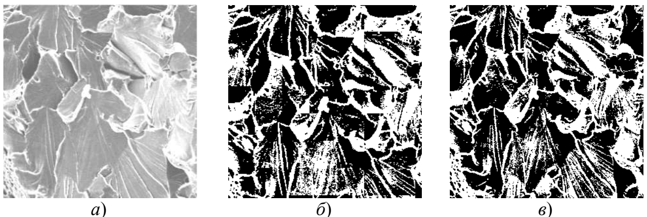
Рисунок 2.13. Результати комп'ютерного моделювання розробленого та відомого методів: а) вхідне зображення; б) обробка вхідного зображення відомим пороговим методом [64]; в) обробка вхідного зображення запропонованим методом [84] при розмірах локальної апертури m \times n = 3 \times 3 та \alpha_1 = 0,6 , \alpha_2 = 0,4 .
