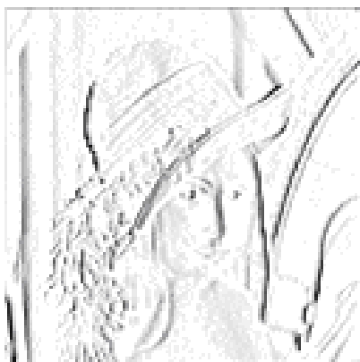
а) зображення I_x , як результат згортки вхідного зображення з фільтром (2.19) по напрямку x .
