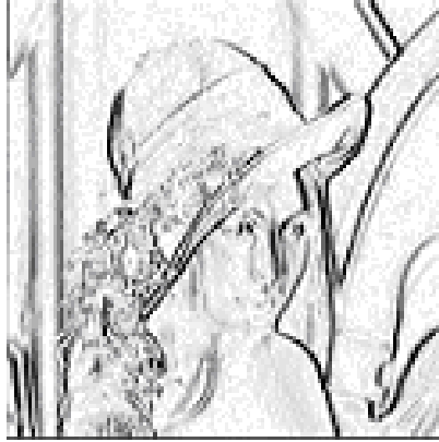
Рис. 2.22. Візуалізація градієнта, обчисленого за виразом (2.21).
