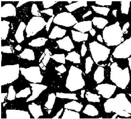
Рис. 1.15. Вхідне зображення після обробки пороговими методами.
