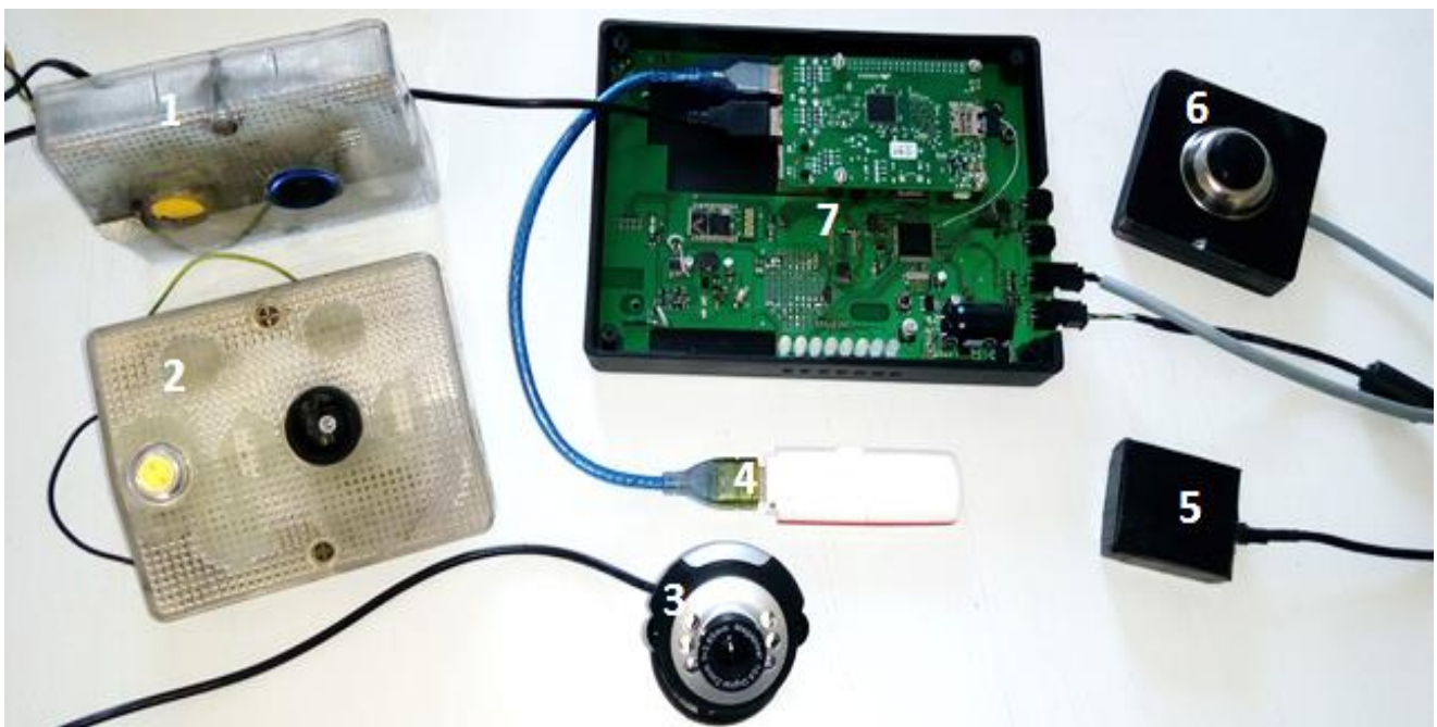
Рисунок 11 – Приклад контролера (1 – плафон з передньою камерою, 2 – плафон з задньою камерою, 3 – USB-камера реєстрації пільгових пасажирів, 4 – GSM-модуль, 5 – GPS-модуль, 6 – кнопка активації USB-камери реєстрації пільгових пасажирів)
