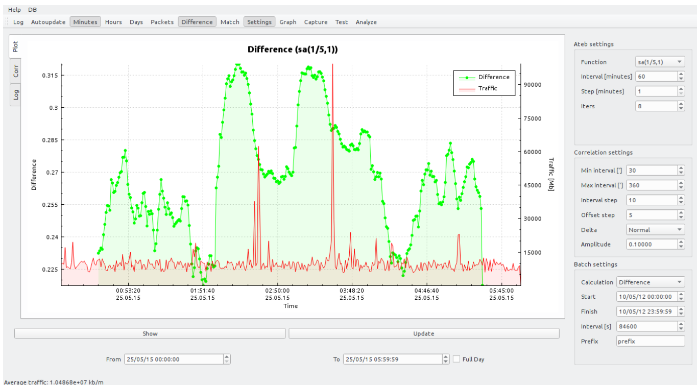
Рис.3.49 Моніторинг даних трафіку комп'ютерній мережі n=1/5 , m=1 .
