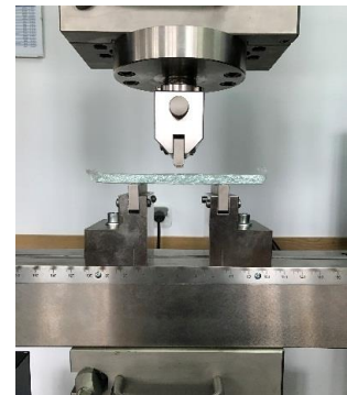
Рис. 3. Випробувальна установка для дослідження скла на розтяг при згині: а) принципова схема; б) загальний вигляд
