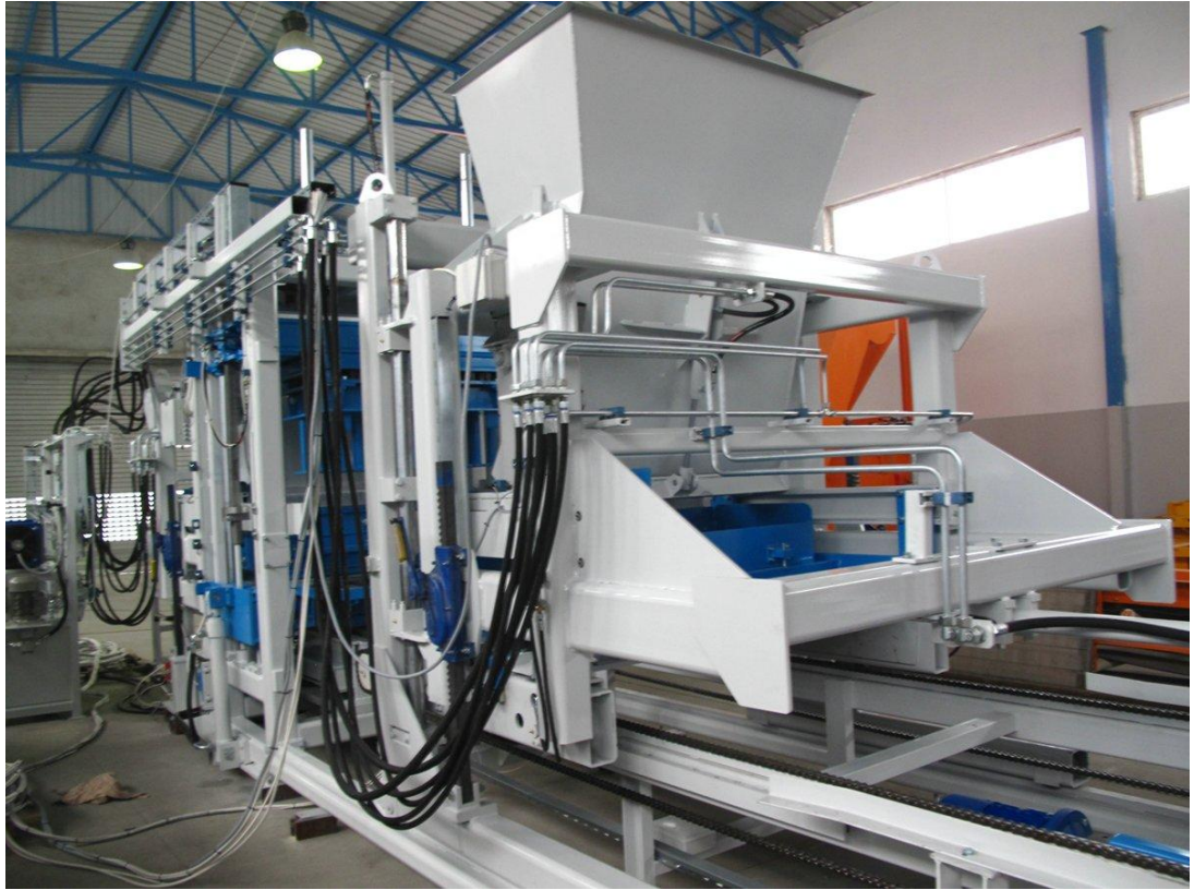
Рисунок 5.1 - Обладнання для виготовлення вібропресованих виробів «PROMETAL UNIVERSAL-1000»
