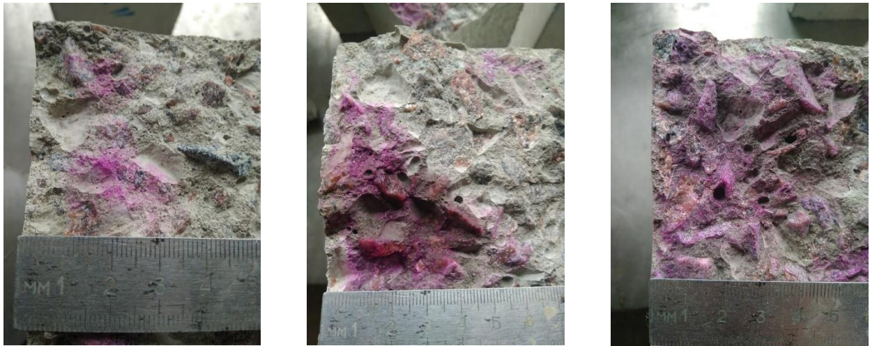
Рисунок 4.20 - Глибина карбонізації крупнозернистих бетонів К(а), ЦПК (б) та ЦПКПв1 (в) після 3 років зберігання у повітряному середовищі
