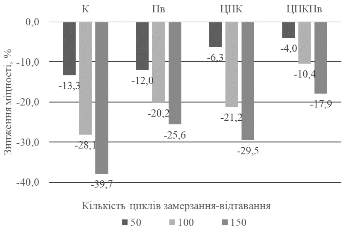
Рисунок 4.5 - Спад міцності бетонів після поперемінної дії циклів заморожування-відтавання
