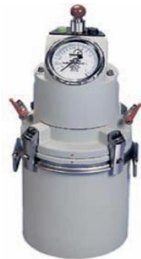
Рисунок 2.4 - Прилад Testing 2.0334 для визначення повітровтягування в бетонній суміші
