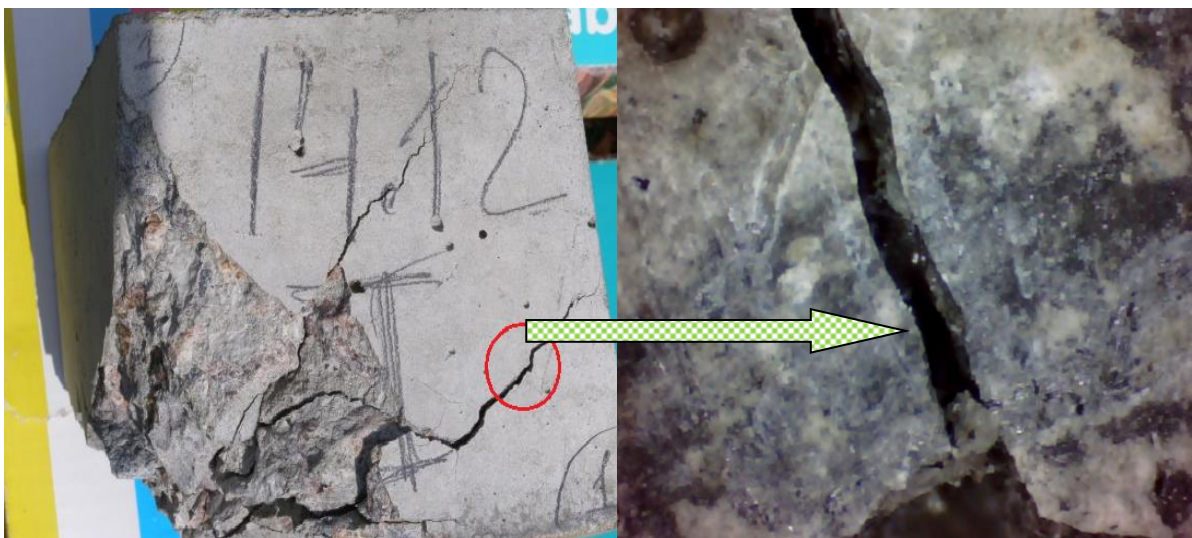
Рисунок 5.25 – Бетон контрольного складу після випробувань на високошвидкісний удар
