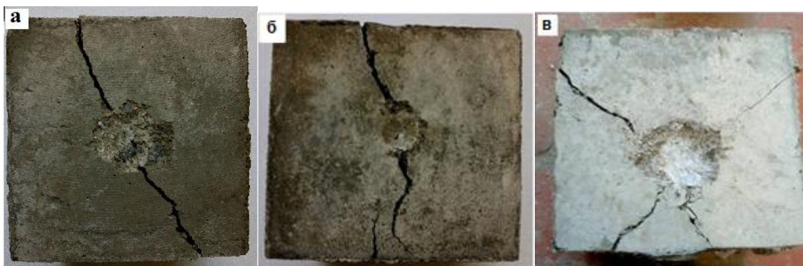
Рисунок 5.24 – Поверхня зразків бетонів після випробування на удар: контрольний (а), на основі наномодифікованих надшвидкотверднучих цементуючих систем (б), наномодифікований дисперсно-армований (в)
