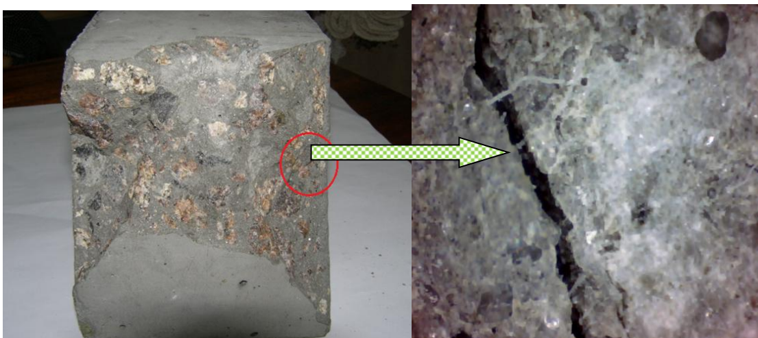
Рисунок 5.26 – Фібробетон на основі наномодифікованої цементуючої системи після випробувань на високошвидкісний удар
