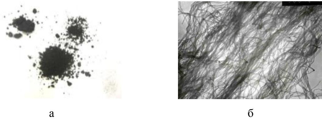
Рисунок 2.13 – Зовнішній вигляд (а) та мікрофотографія (б) вуглецевих нанотрубок
