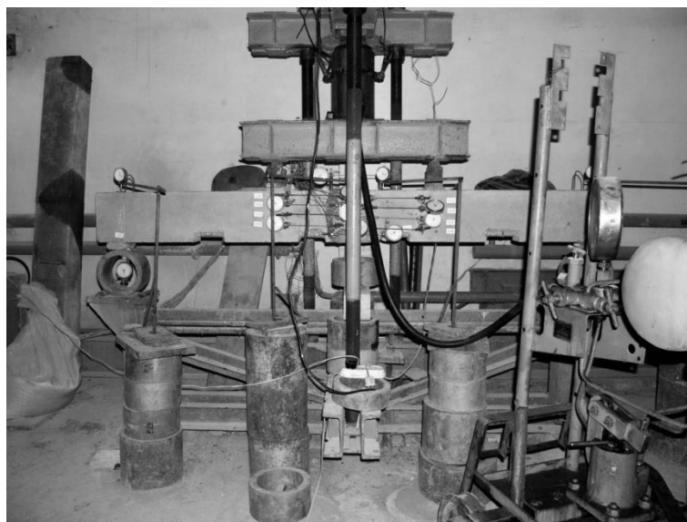
Рис. 1.8. Загальний вигляд стенда для випробувань балок, підсилюваних нарощуванням розтягнутої стрижневої арматури при дії навантаження (шляхом її приварювання через коротиші).
