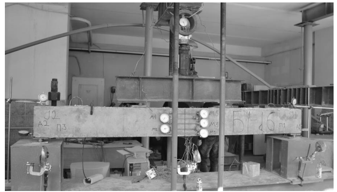
Рисунок 3 – Випробування базальтобетонної балки у силовому стенді
