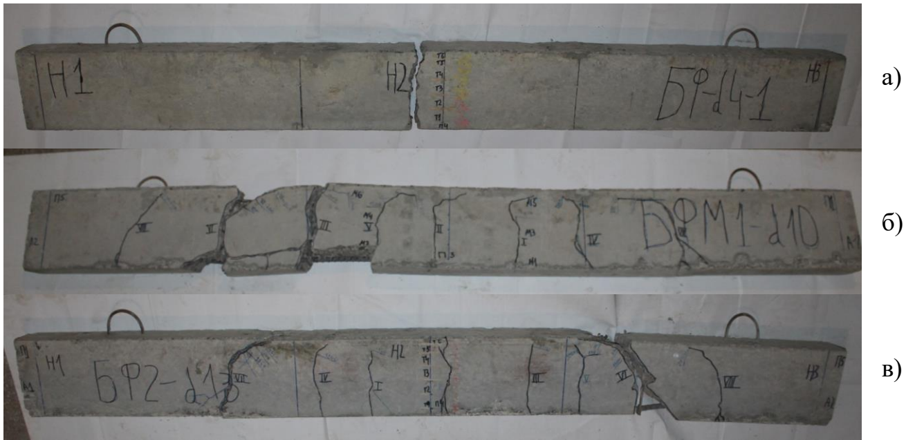
Рисунок 5 – Характер руйнування випробуваних дослідних зразків
