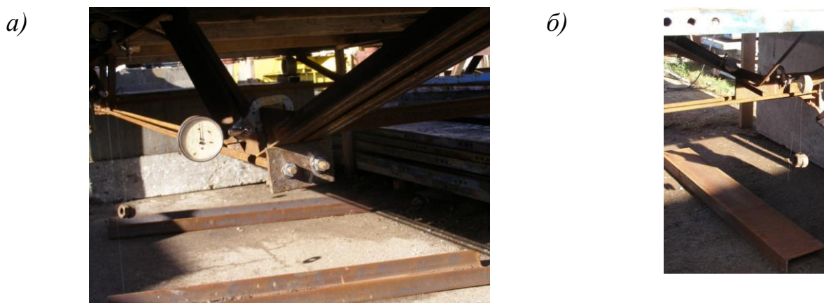
Рис. 4.5. Монтаж дослідного обладнання на МШК
