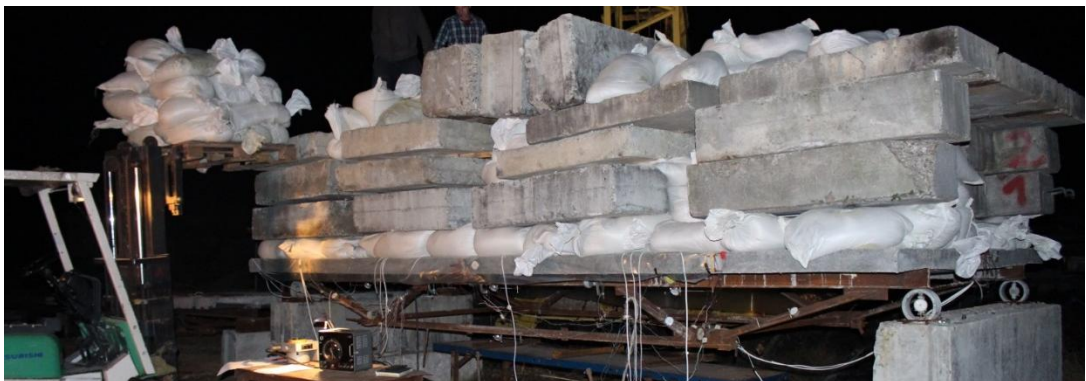
Рис. 4.16. Стадії навантаження дослідних ПНШК
