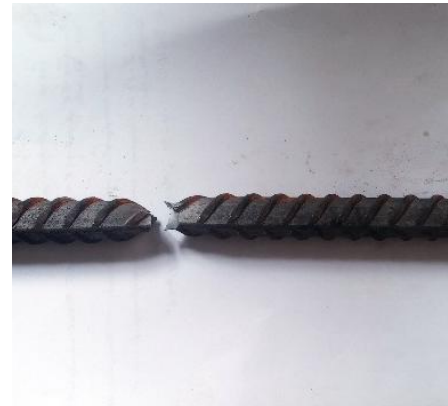
Рис. 4.15. Випробування на розрив зрізків арматури
