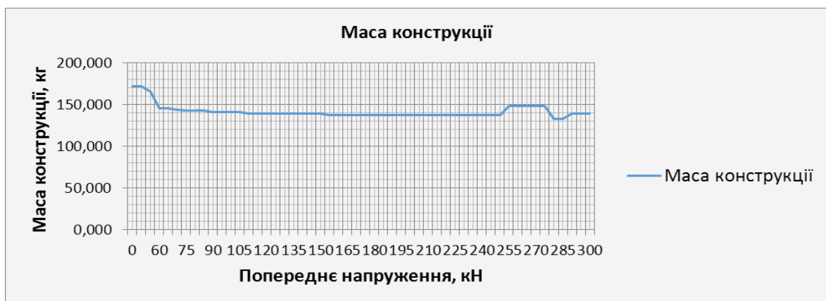
Рис.2.9. Зміна маси статично невизначеної комбінованої металевої шпренгельної конструкції в залежності від величини натягу затяжки
