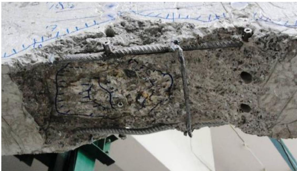
Рис. 3.4. Руйнування стиснутої зони зразка КП-03-0,0.
