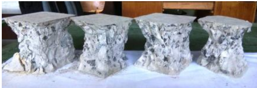
Рис. 2.9. Випробування зразків бетону.
