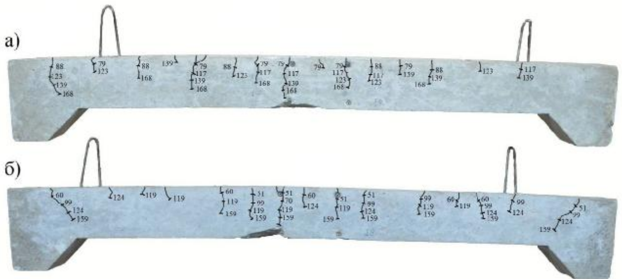
Рис. 3.2. Загальний вигляд непідсилених колон після випробування:
