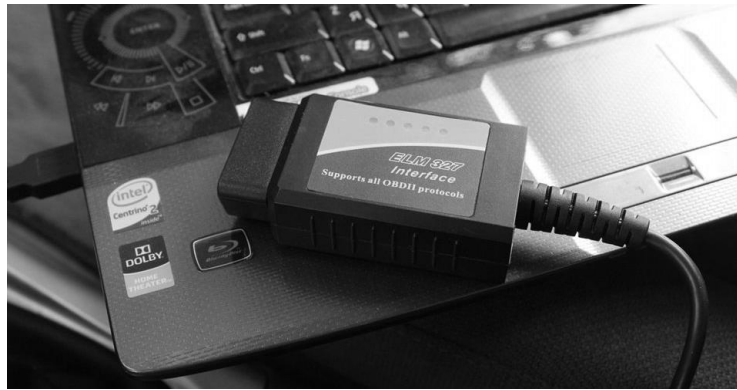
Рисунок 3.10 – Діагностичний пристрій, підключення через OBD II
