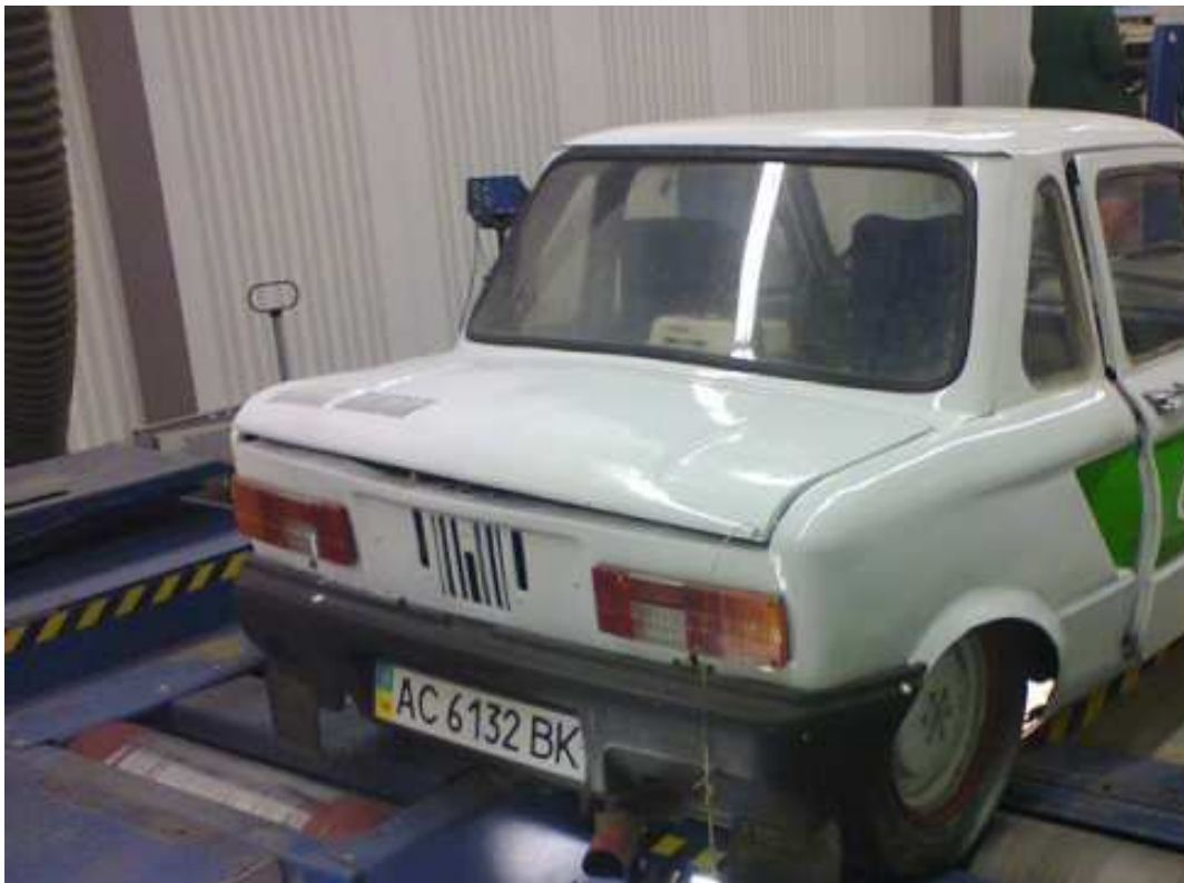
Рисунок 3.1 – Об'єкт випробувань – Легковий автомобіль з гібридною силовою установкою ГСУ-1
