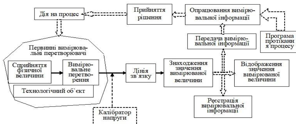
Рисунок 1.1 – Узагальнена структурна схема вимірювальних каналів технологічних КФС
