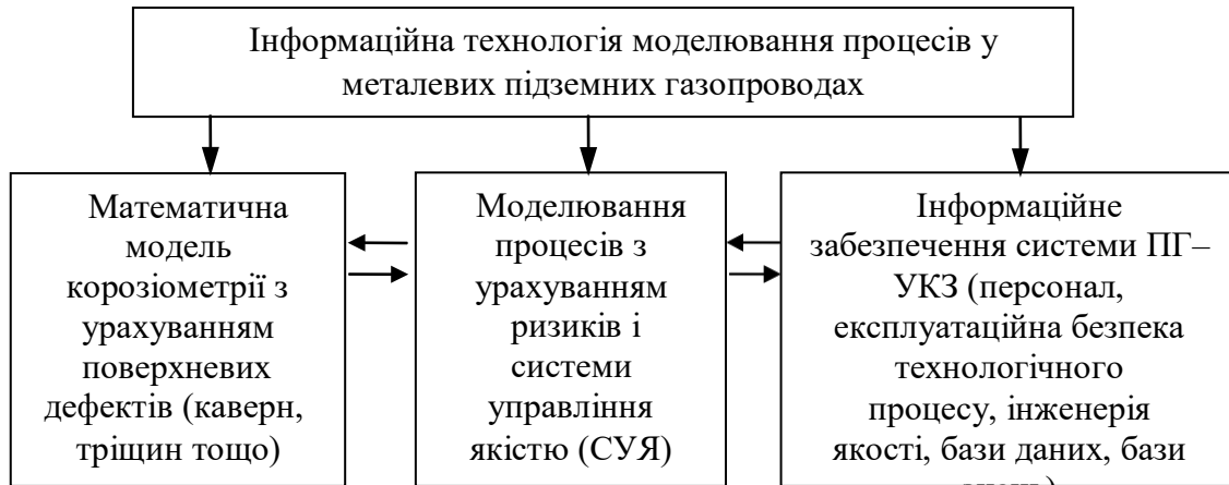
Рисунок 3 – Структурна схема інформаційної технології для моделювання процесів у підземних газопроводах
