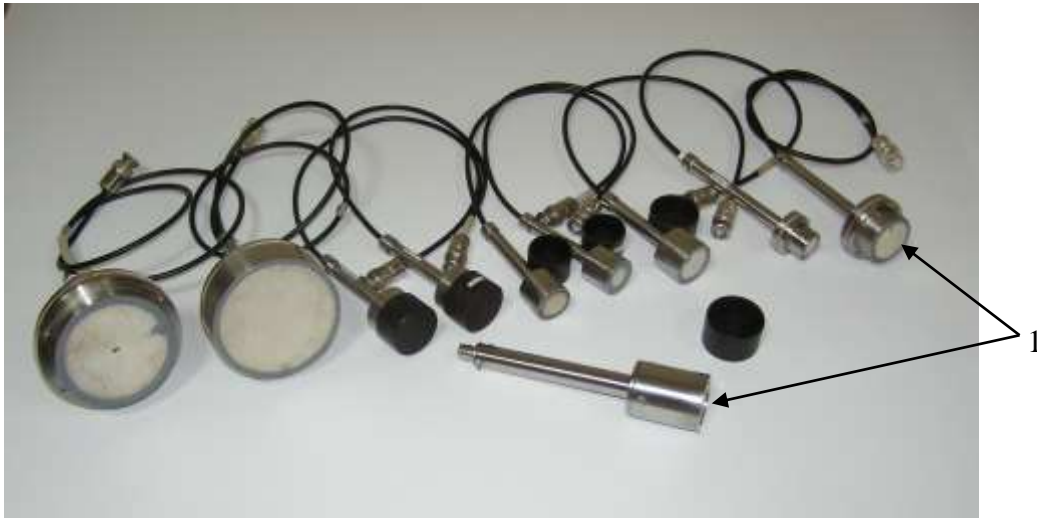
Рисунок 2.6 – Комплект УЗВ з п'єзокерамічними та п'єзоелектричними монокристалічними дисковими чутливими елементами:
