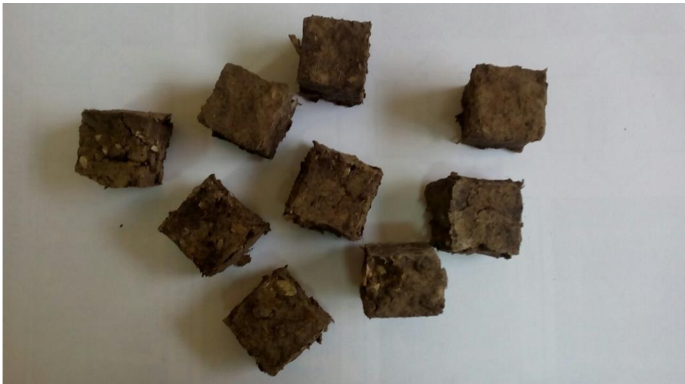
Рисунок 2.9 - Загальний вигляд композиції органічного добрива у вигляді кубиків 15×15×15 мм.
