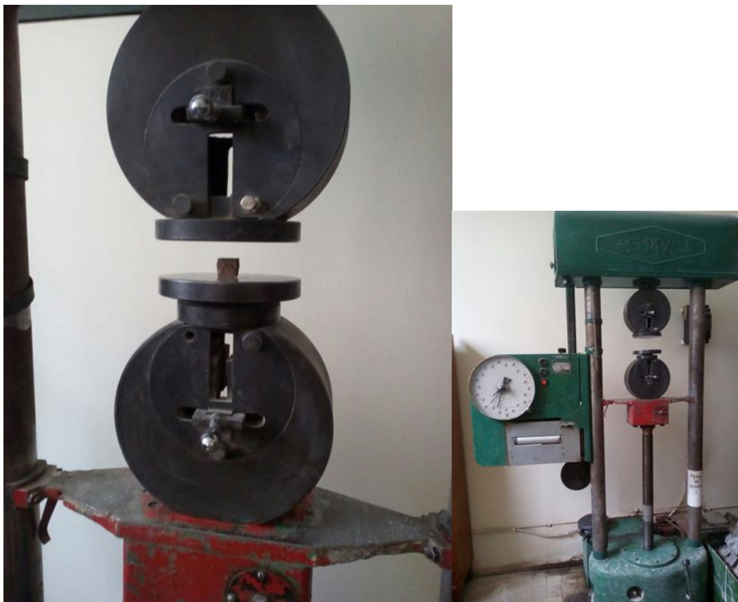
Рисунок 2.10 - Фотографії універсального пресу УММ-5.
