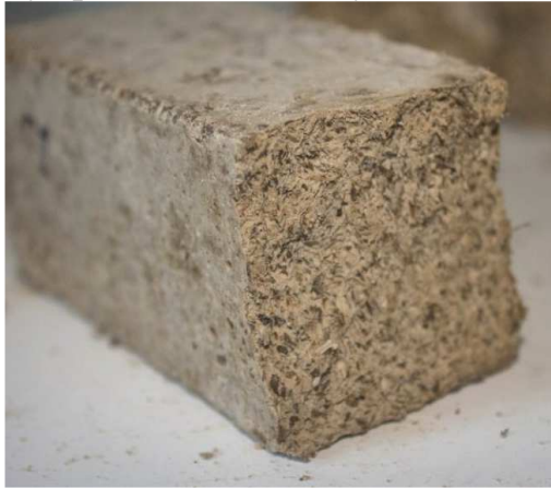
Рис. 3 - Зовнішній вигляд зламу зразка гіпсового будівельного матеріалу на основі опалого листя
