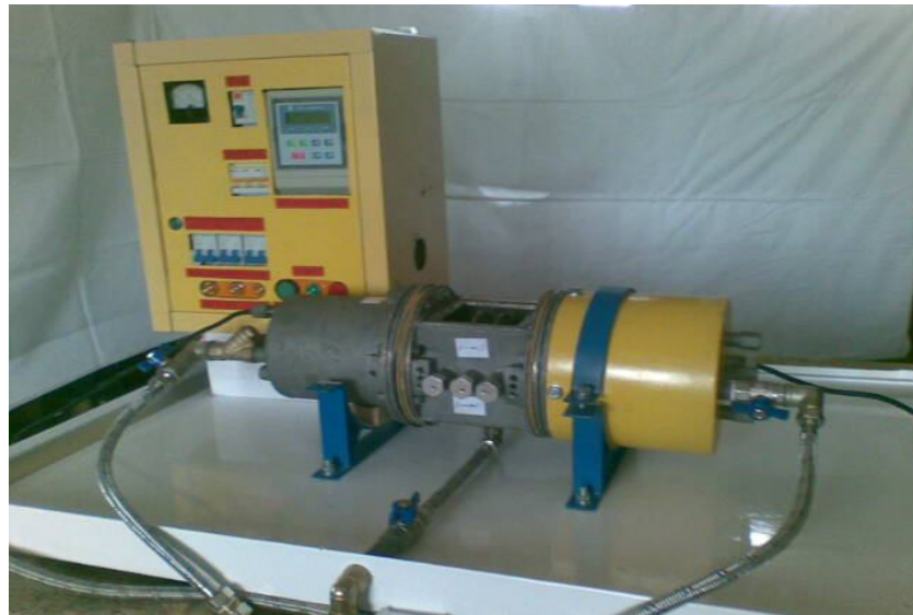
Рис. 2.3. Принципова схема та світлина електромагнітного кавітатора для кавітаційної обробки водних розчинів із високим вмістом МЧ та ХСК під тиском та при підвищених температурах [81]
