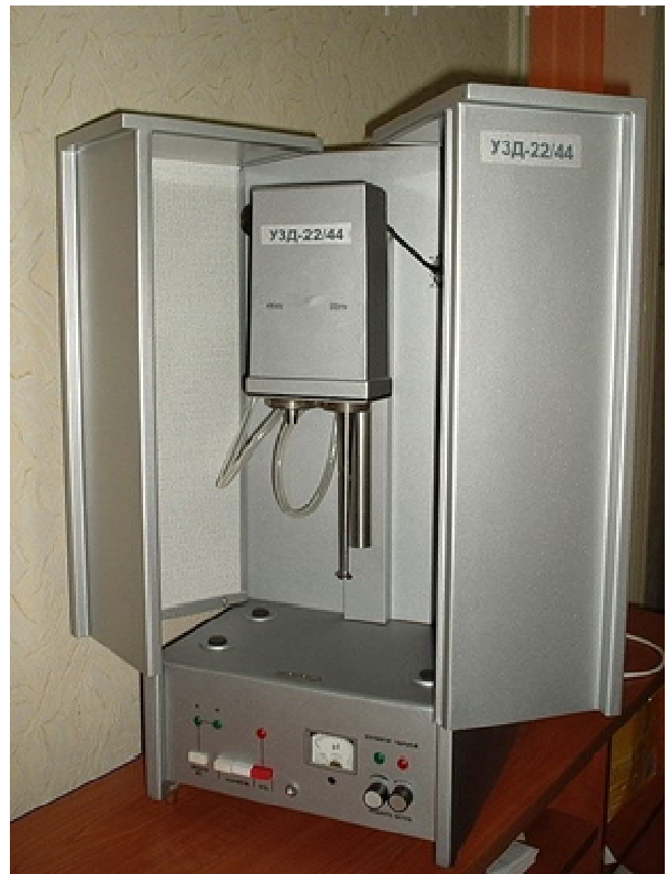
Рис. 2.1. Схема та світлина реактора для окиснення домішок органічних речовин та знезараження мікроорганізмів в ультразвуковому полі; 1 – магніостріктор, 2,8,9 – ущільнення, 3 – хвилевід, 4 – реактор, 5 – штуцери для теплоносіїв, 6 – термопара, 7 – штуцери вводу газів, 10,11 – накидні гайки, 12 – штуцери виходу газів, 13 – пробовідбірник.
