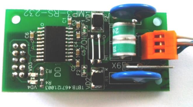
Рис. 4.3. Плата перетворювача інтерфейсів USART – RS485 з гальванічною розв'язкою та грозозахистом.
