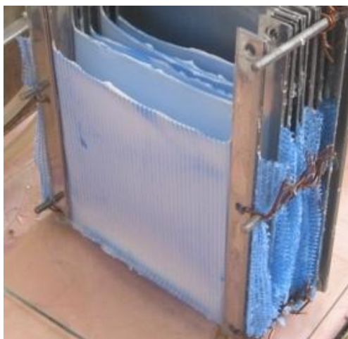
Рис.7.2. Фотографія гідрогелевих пластин після проведення стадії відмивання від низькомолекулярних сполук та висушування.
